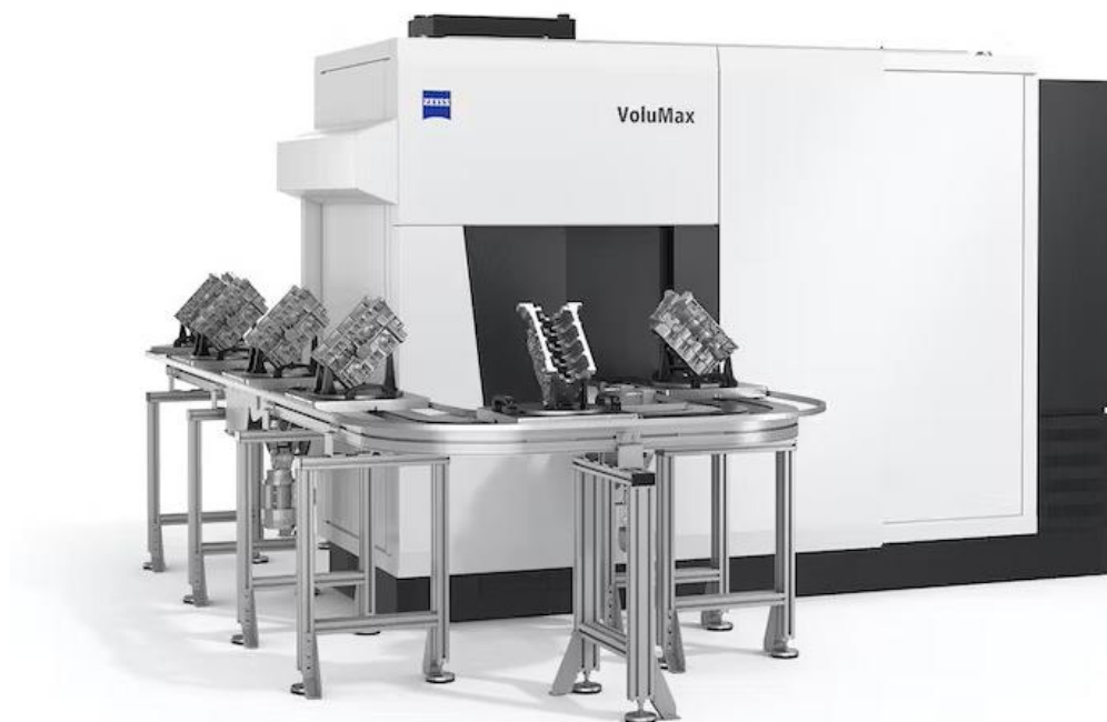
Obrázek 33 - Automatizovaný proces měření pomocí CT (16)
