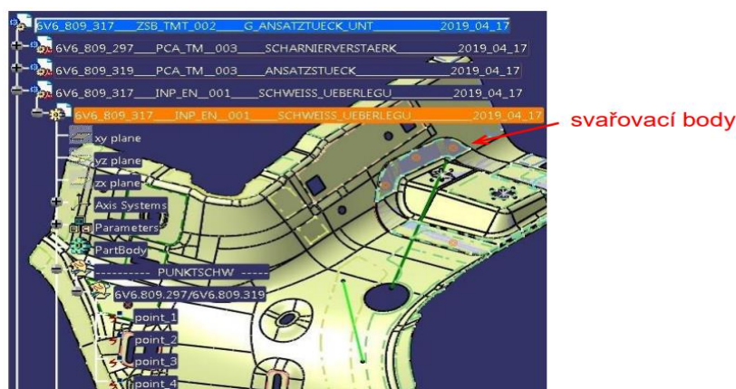
Obrázek 12: Díl s definovanými body svaření [37]
