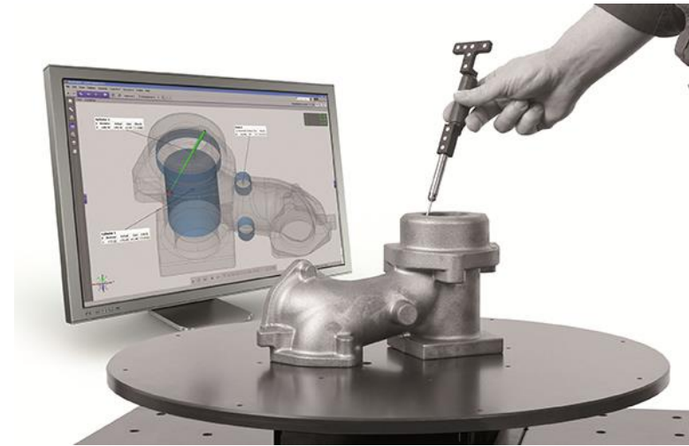
Obrázok 2 – Kontaktná metóda skenovania – scanning probe[19]
