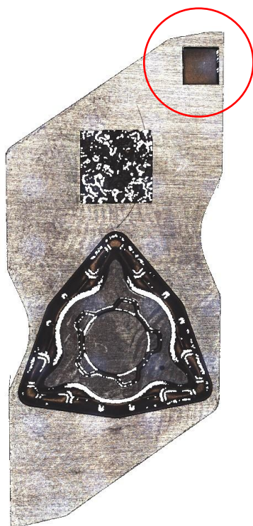
Obrázok 43 - Útvar použitý na zistenie hĺbky ablačného odberu
