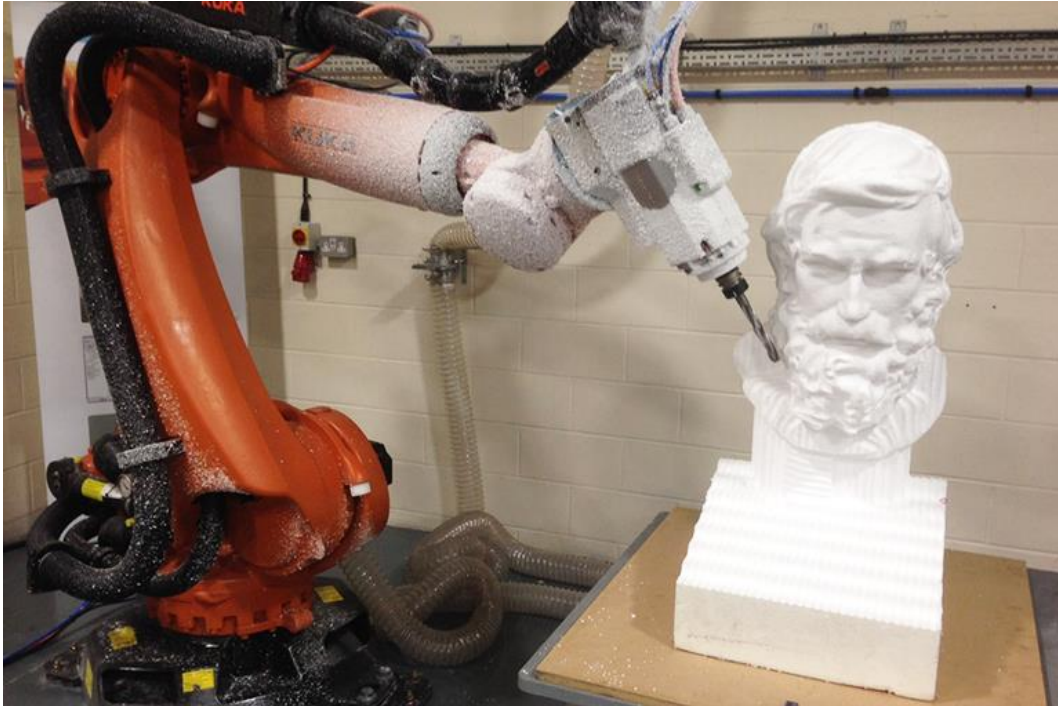
Obrázek 42 Příklad 5D obrábění pomocí průmyslového robotu [50]
