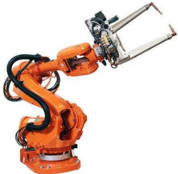
Obrázek 40 Průmyslový robot vybavený bodovacími kleštěmi pro tlakové svařování [27]
