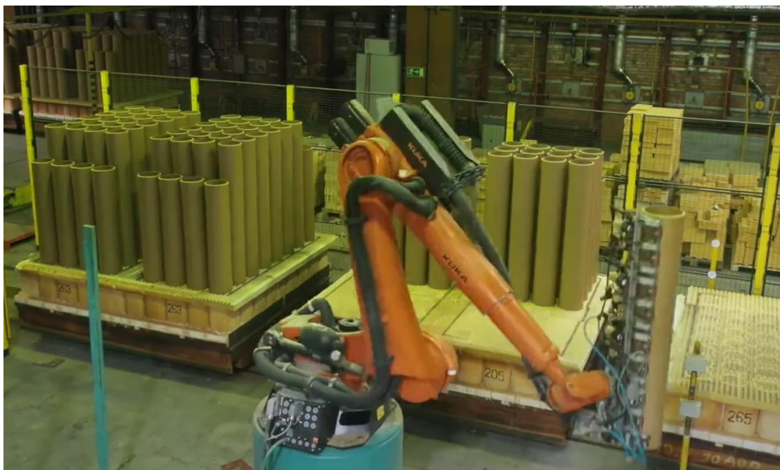
Obrázek 63 Rovnání syrových komínových vložek na pecní vozy [42]
