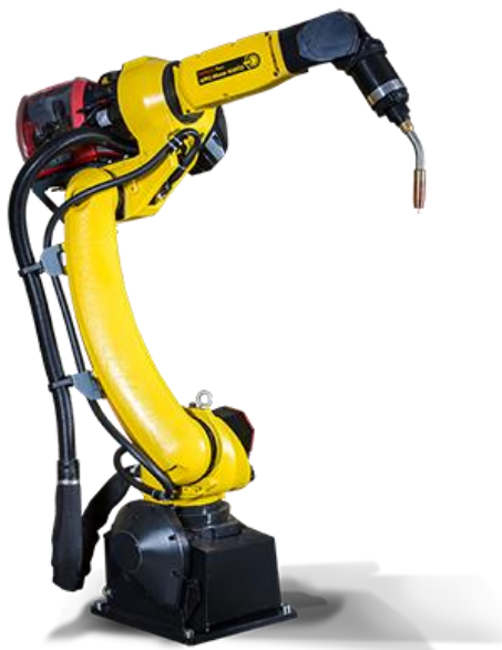
Obrázek 39 Robot pro obloukové svařování Fanuc ARC Mate 100iD [43]
