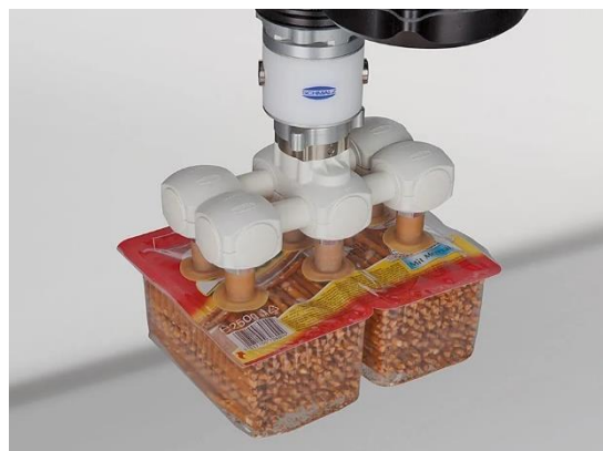
Obrázek 27 Příklad použití podtlakové manipulační hlavy v oblasti balení a logistiky potravin [53]
