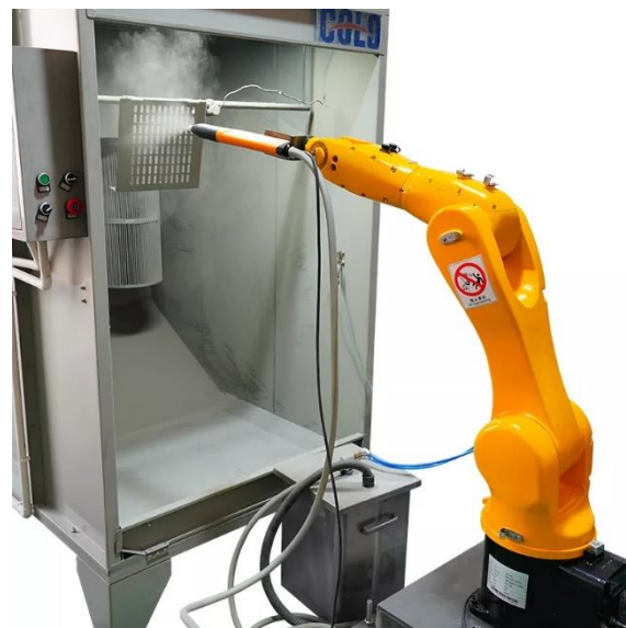
Obrázek 44 Práškové lakování pomocí šestiosého angulárního robotu [51]
