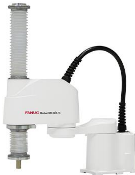
Obrázek 15 SCARA robot Fanuc SR-3iA/C [48]
