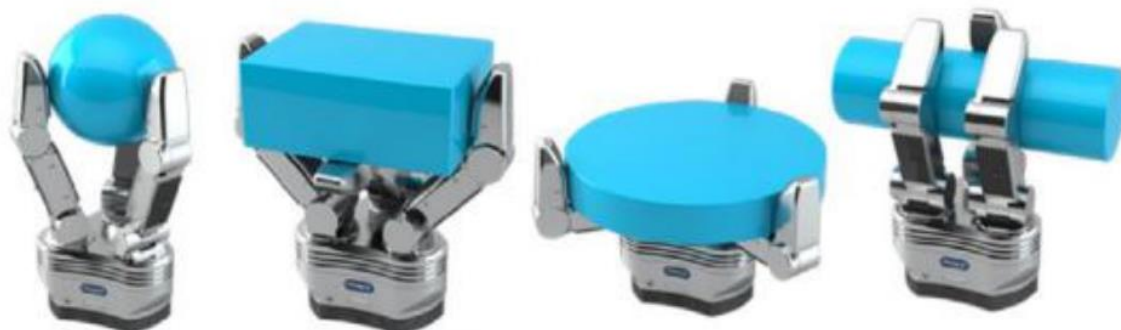
Obrázek 20 Možné způsoby úchopu základních tvarů pomocí konvenčních chapadel [28]
