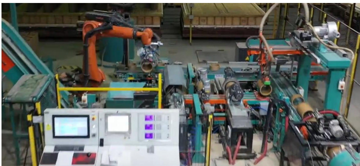
Obrázek 62 Výrobní linka keramických komínových vložek [42]
