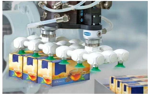
Obrázek 33 Použití jednobříté ploché přísavky [53]
