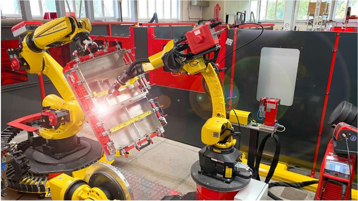
Obrázek 41 Plně robotizovaný proces svařování [49]
