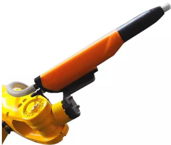
Obrázek 43 Příklad práškovací pistole na zápěstí průmyslového robotu [51] – detail
