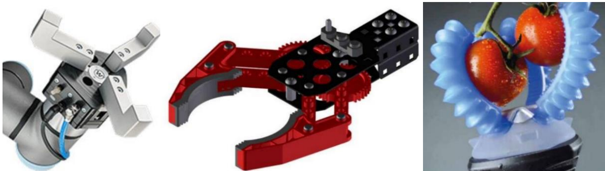
Obrázek 22 Příklady konstrukčních pojetí aktivní mechanické úchopné hlavice. Zleva: Chapadlo se třemi posuvnými úchopnými prvky, chapadlo se dvěma otočnými úchopnými prvky a chapadlo se čtyřmi pružnými, otočnými úchopnými prvky [26] [33] [32]
