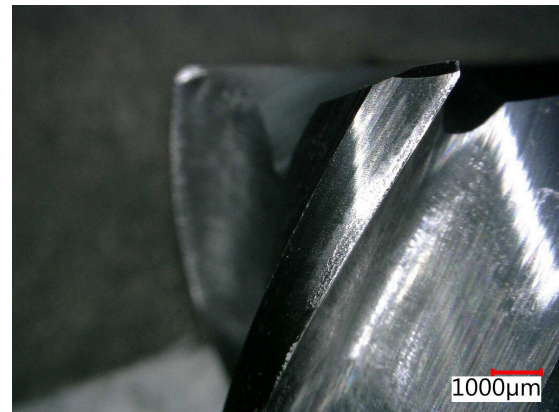
Obrázek 55: Tvorba nárůstku na hřbetě nástroje
