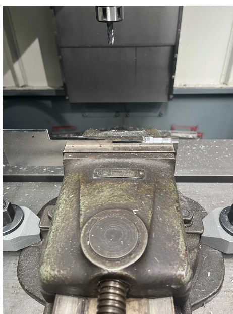
Obrázek 39: Polotovar pro určování měrné řezné síly - plech 5 mm, upnutý
