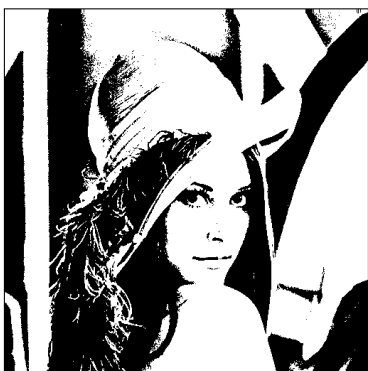
Obrázek 2.5: Prahování vstupního obrazu pomocí prahu P = 117 získaného z Otsuovy metody
