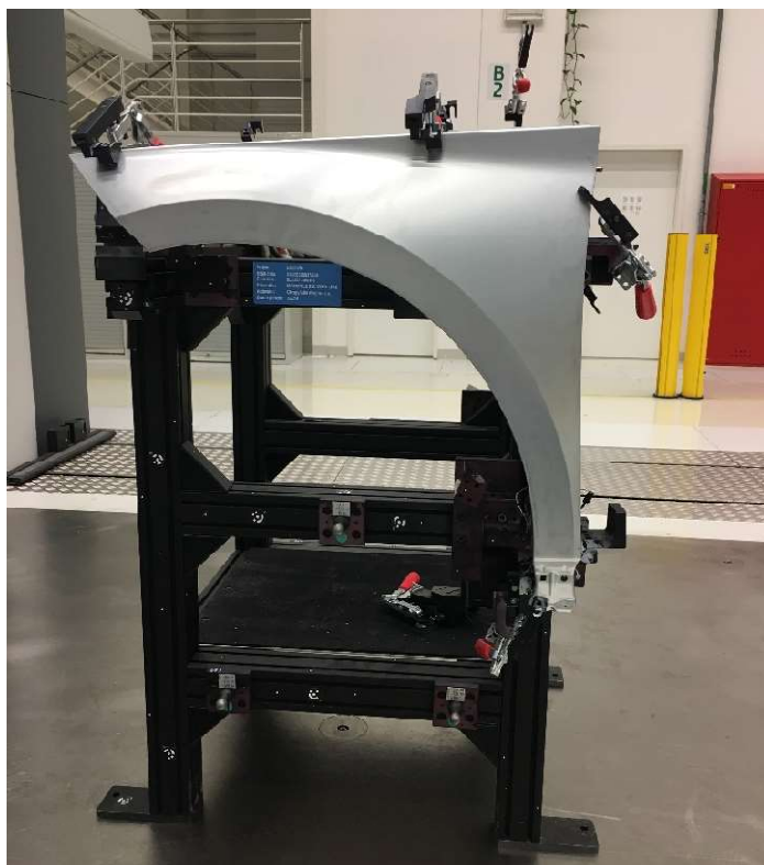
Obrázek 20 - Zkušební díl upnutý ve standardním rámovém přípravku
