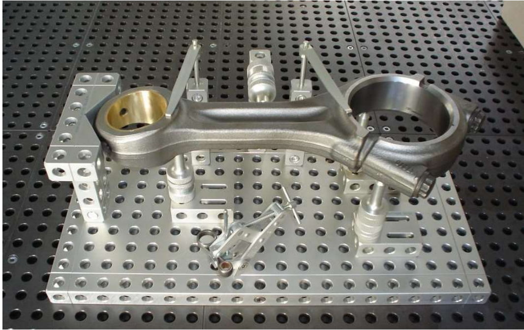
Obrázek 13 - Přípravek sestavený z upínacího systému Alufix [21]
