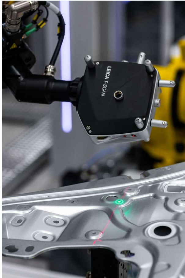
Obrázek 8 - Laserový skener Leica T-scan 5 upnutý na průmyslovém robotu [8]
