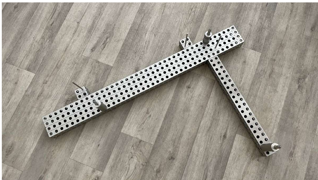
Obrázek 23 - Přípravek složený ze systému Alufix
