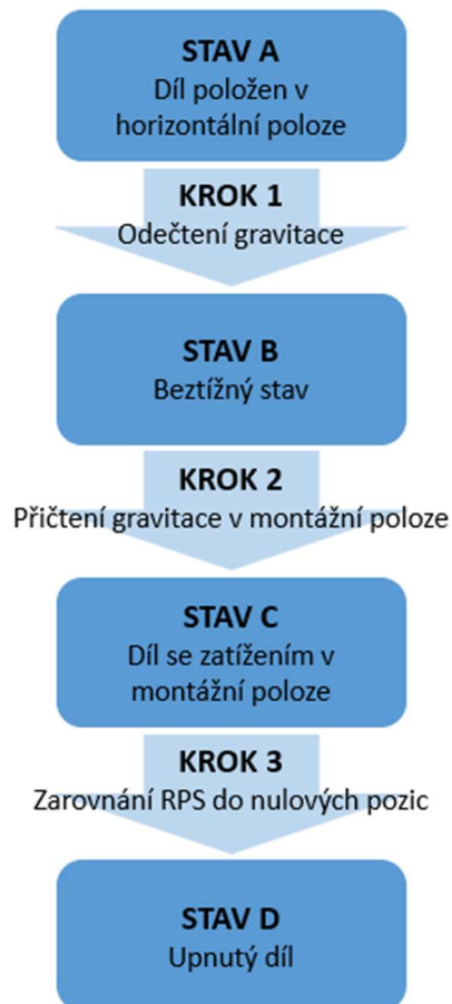
Obrázek 17 - Postup simulace virtuálního upínání, převzato a upraveno z [32]
