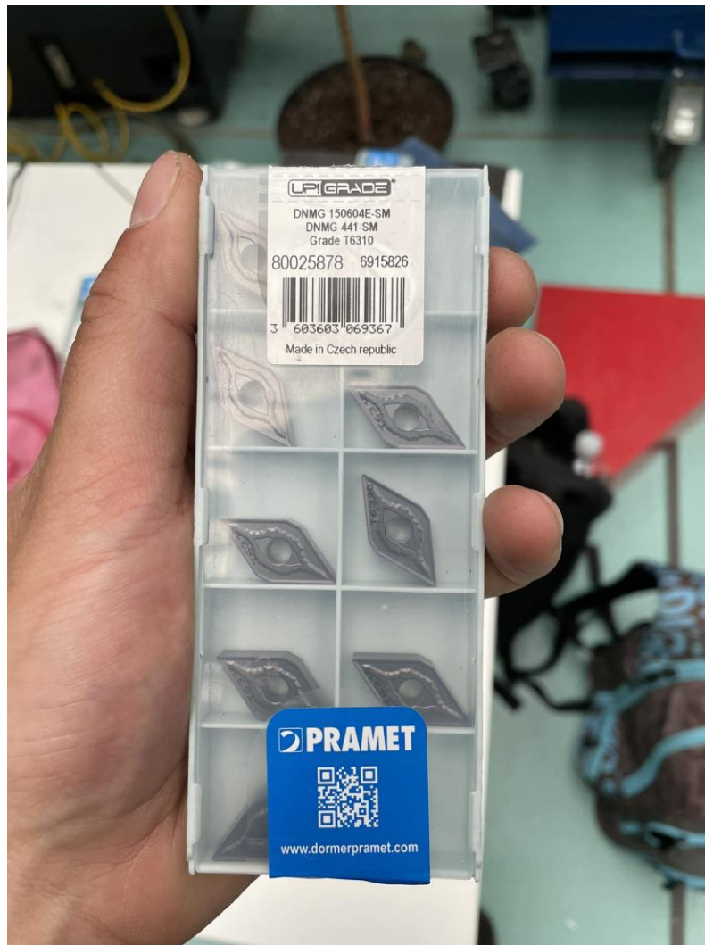
Obrázek 23 - VBD pro dohrubování vnější kontury
