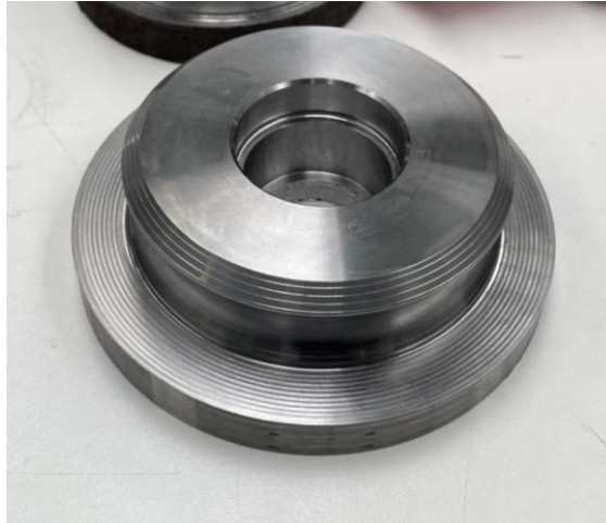
Obrázek 43 - Obrobená součást z první strany v žíhaném stavu
