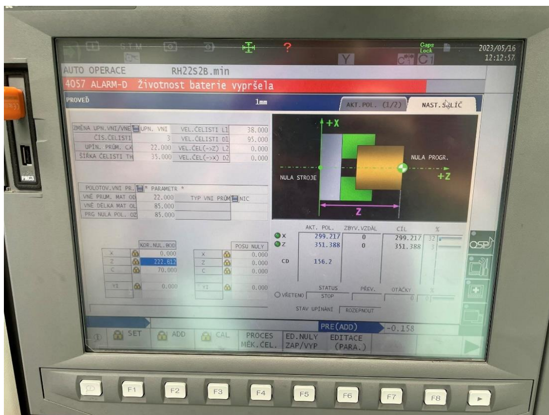
Obrázek 41 - Zápis nulového bodu do stroje
