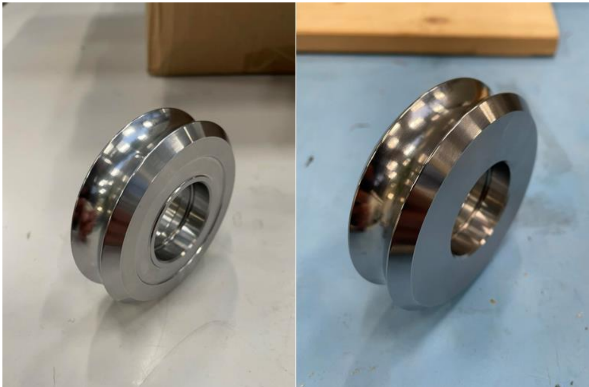
Obrázek 42 – Obrobená součást z druhé strany v žíhaném stavu
