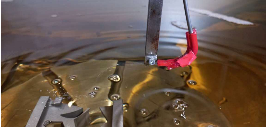
Obrázek 41.: Proudící dielektrikum z trubičkovité nástrojové elektrody
