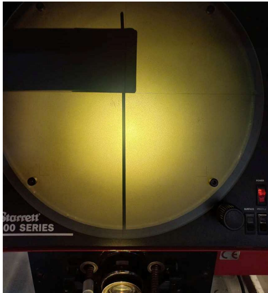
Obrázek 42.: Horizontální profil projektor Starrett 400 series s aktuálně měřenou elektrodou
