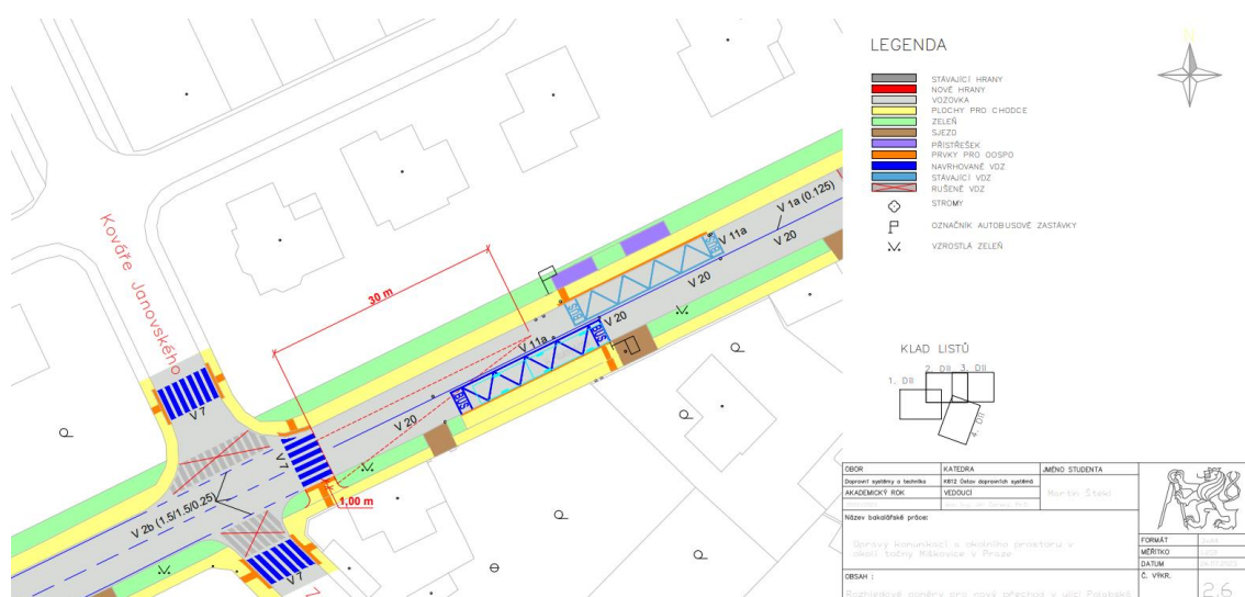
Obrázek 95 - Rozhledové poměry pro nový přechod v ulici Polabská, příloha 2.6 (zdroj: autor)
