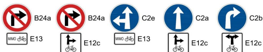
Obrázek 31 - Značení před křižovatkami s povoleným směrem jízdy cyklistů navíc oproti ostatním vozidlům (zdroj: [13])
