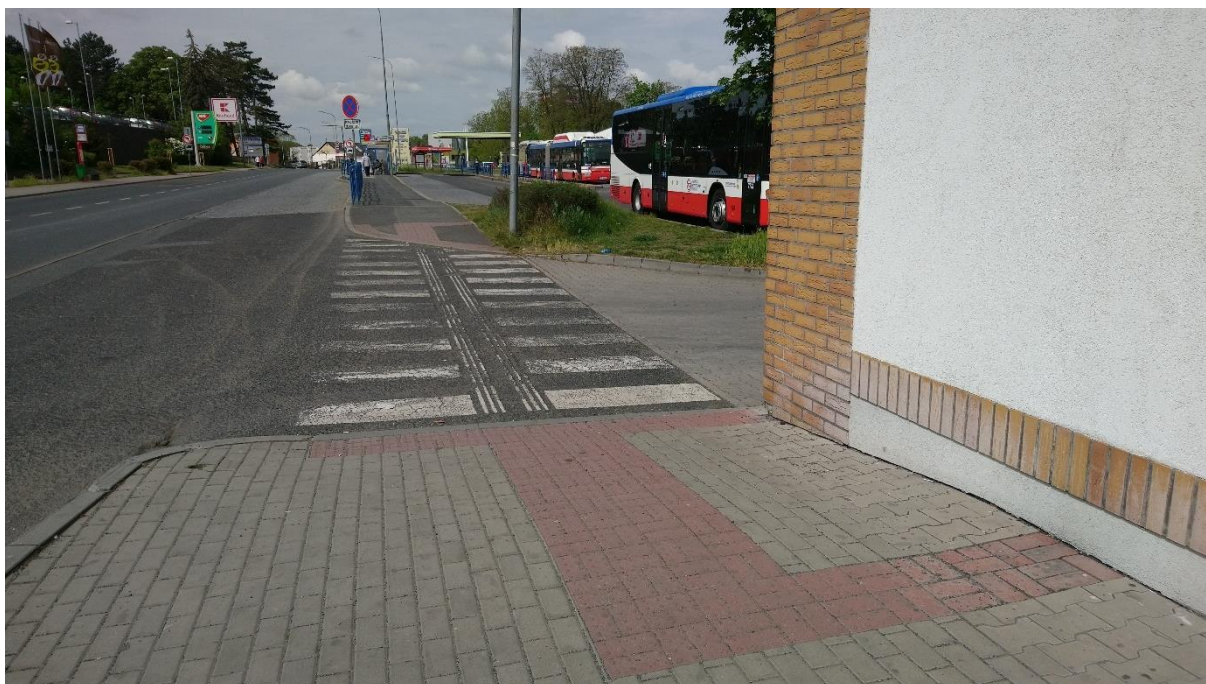
Obrázek 22: Přechod pro chodce, který vede přes vjezd do areálu pro vozidla zásobování. Vlevo za přechodem je dlažbou vyznačena plocha, z níž vozidla do areálu couvají.
