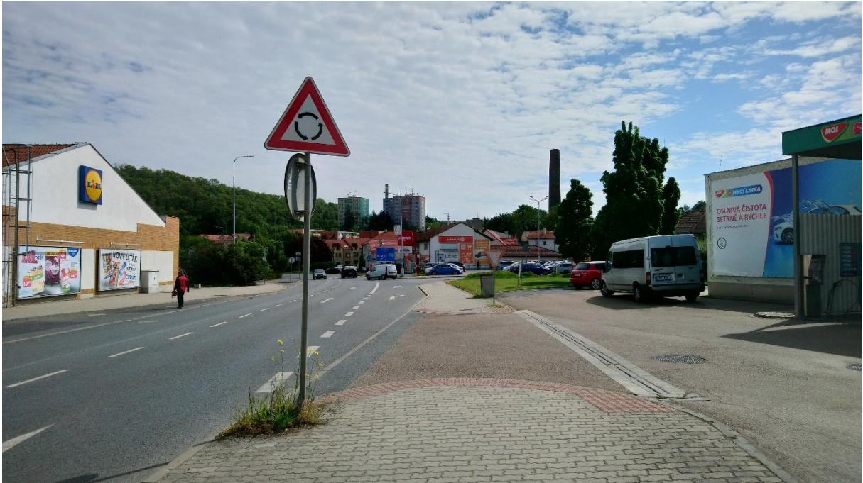
Obrázek 29: Neodpovídající řešení místa pro přecházení (deficit č. 22). Za povšimnutí stojí nevhodné řešení výjezdu z ČSPH (viz sekce 3.2).
