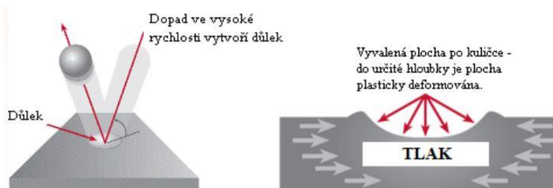
Obrázek 7 - Dopadnutí kuličky na povrch a výsledná plocha po dopadu [26]
