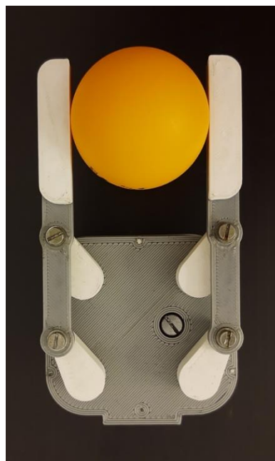
Obr. 66 Nový prototyp svírající míček na stolní tenis
