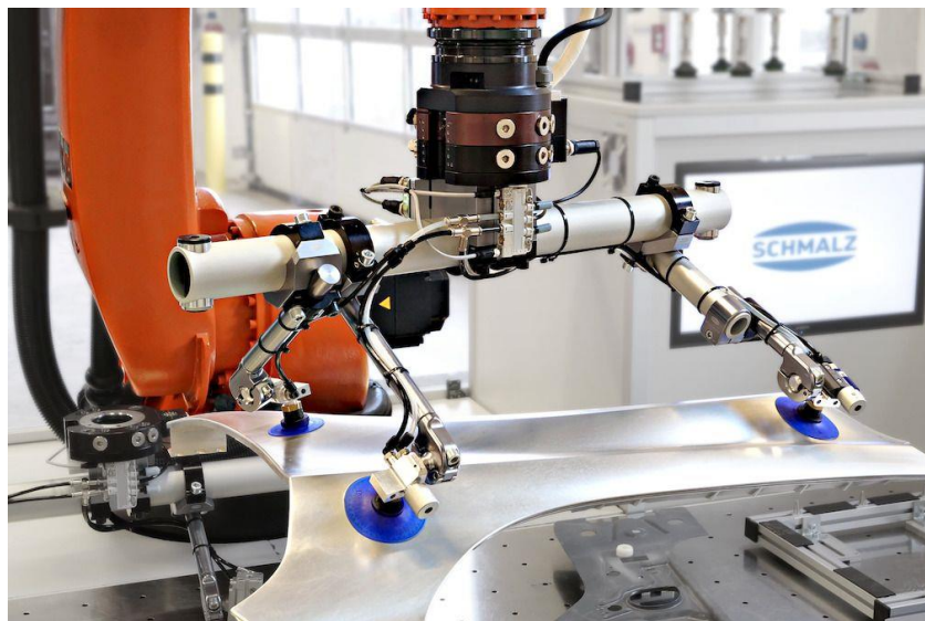
Obr. 5 Přísavková úchopná hlavice při manipulaci s výliskem karoserie [15]
