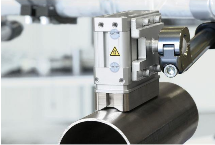
Obr. 6 Magnetická úchopná hlavice při manipulaci s ocelovou trubkou [16]
