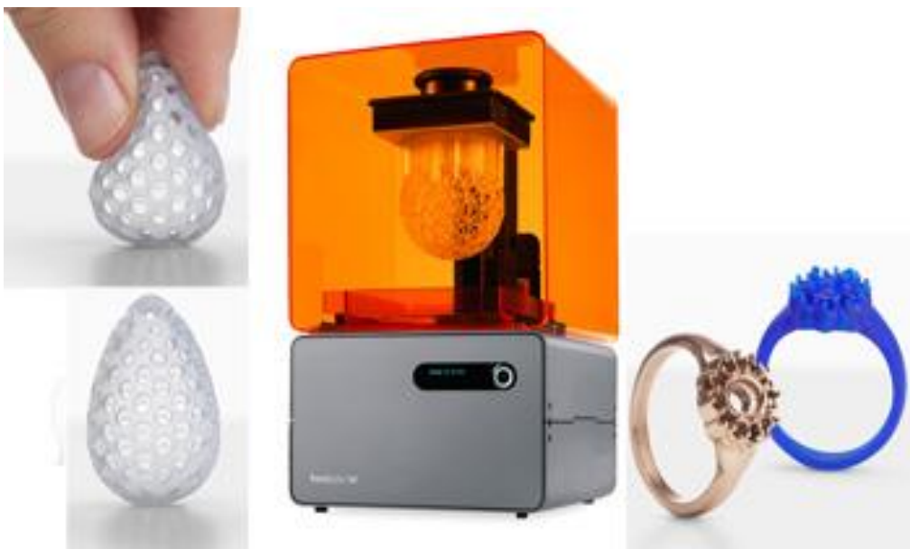
Obrázek 7: Způsob tisku a ukázka materiálů pro tisk metodou SLA. [16]
