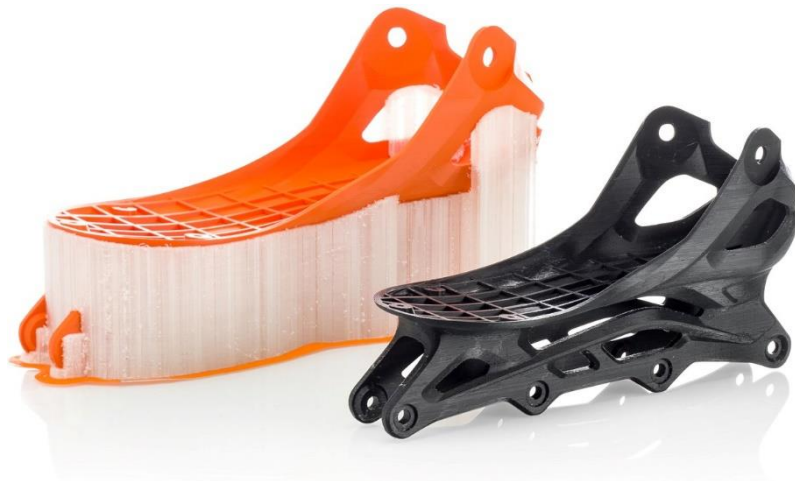
Obrázek 15: Rozpustné podpory z PVA. [26]
