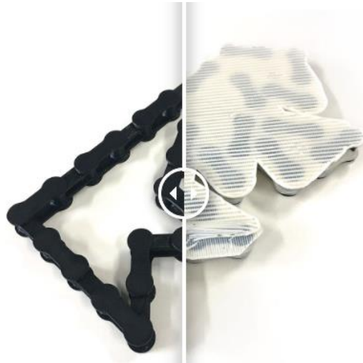
Obrázek 22: Rozdíl po a před automatizovaným opracováním povrchu (podpěry, 5 min). [30]
