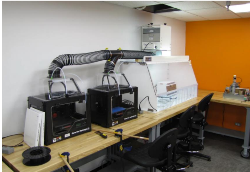
Obrázek 23: Možnost ventilace při FDM tisku. [31]
