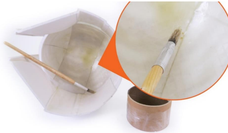
Obrázek 19: Vyztužování výtisku laminátem. [27]
