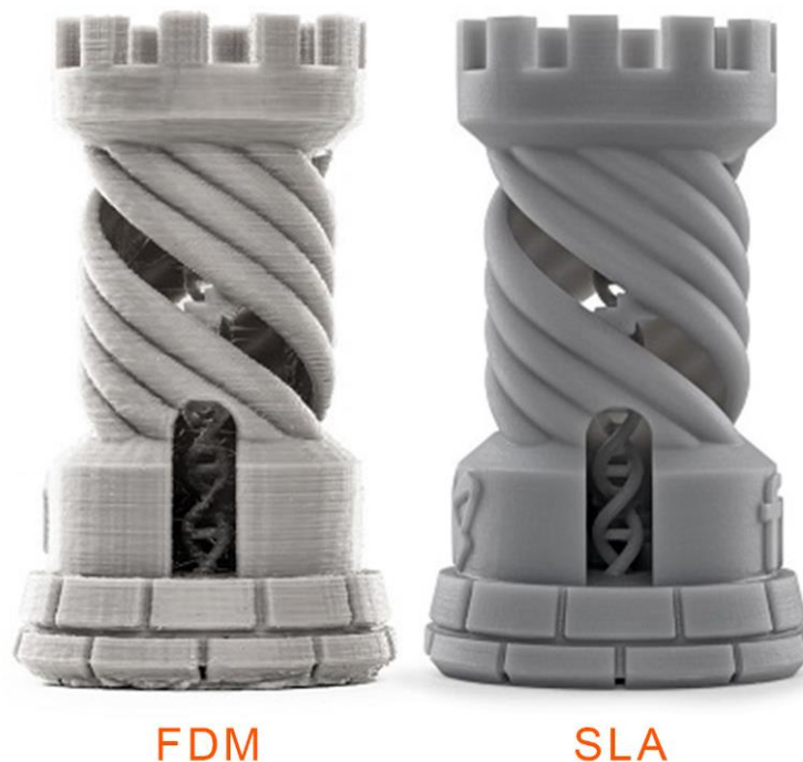
Obrázek 8: Porovnání kvality výtisků technologií FDM a SLA. [18]
