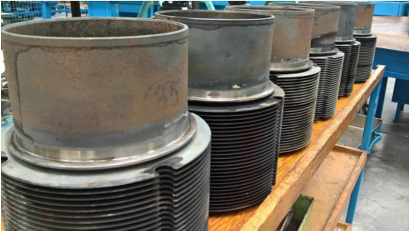
Obr. 22: Neodstranitelná koroze na hladké části válce [autor]
