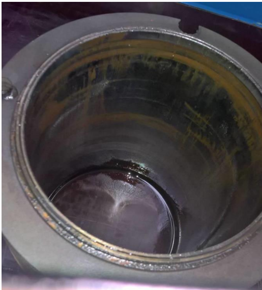
Obr. 20: Těžko odstranitelná vnitřní koroze [autor]
