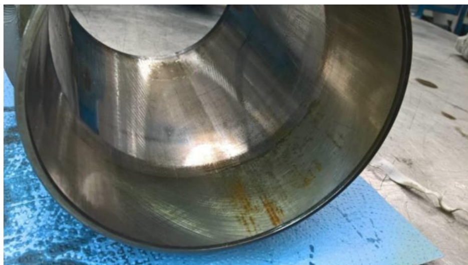
Obr. 19: Odstranitelná vnitřní koroze lehká [autor]
