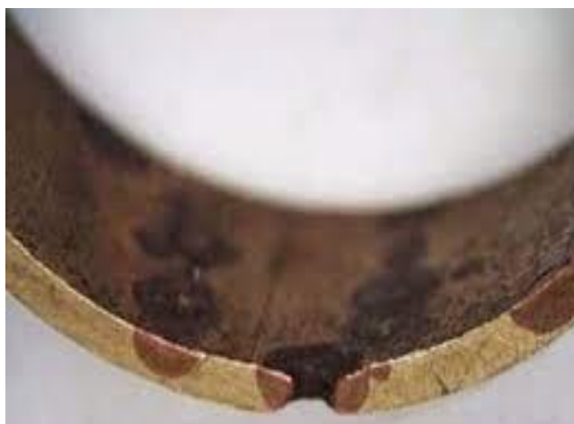
Obr. 8: Selektivní koroze – odzinkování mosazi [7]
