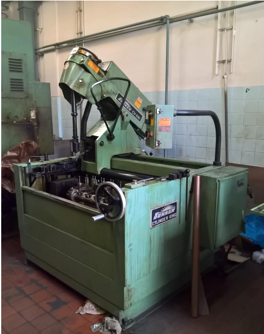
Obr. 21: Honovací nástroj SUNNEN CV-616 [autor]
