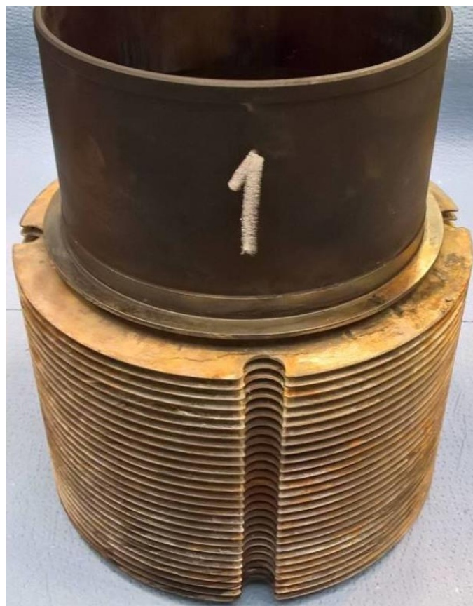
Obr. 23: Neodstranitelná koroze na žebrované části válce [autor]
