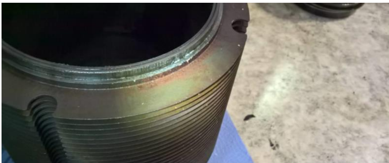
Obr. 24: Odstranitelná vnější koroze [autor]
