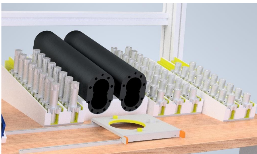
Obr. 33 – Spádové dráhy umístěné na stole
