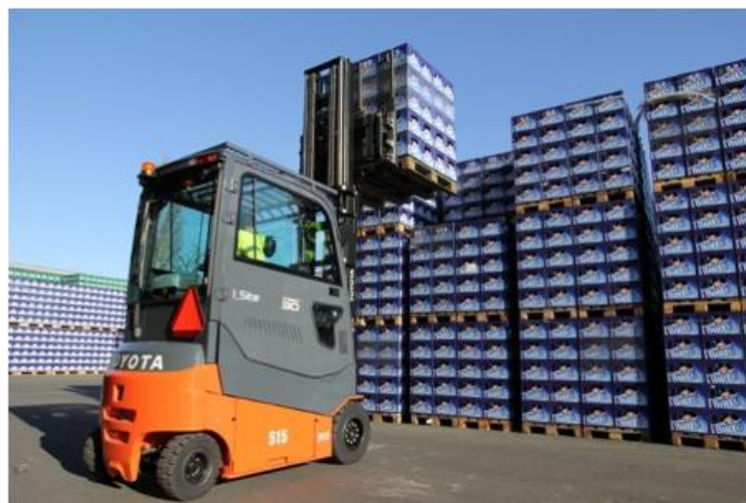
Obrázek 2.7-2 - Podlažní skladování v řadách stohované [17]
