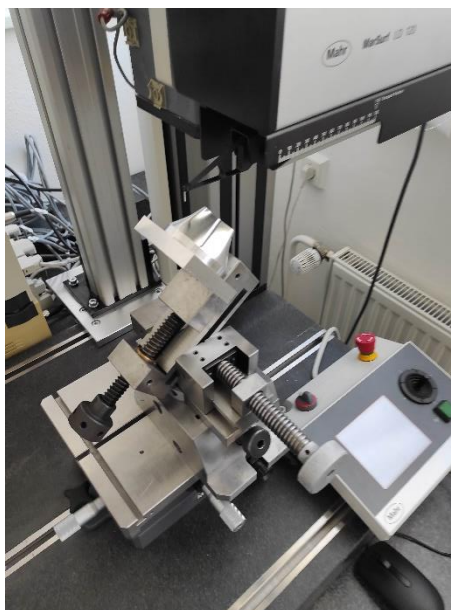
Obr. 22 Polohování výrobku na konturografu pomocí dvou svěráků
