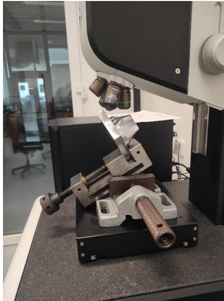
Obr. 24 Polohování na konfokálním mikroskopu pomocí dvou svěráků
