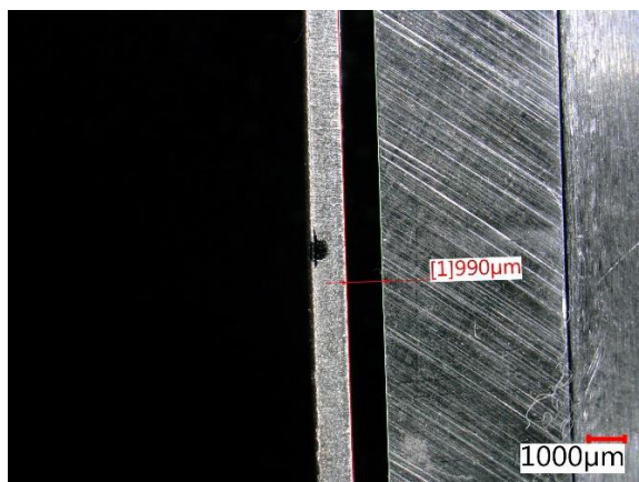
Obrázek 26: Tryskání při 3 barech
