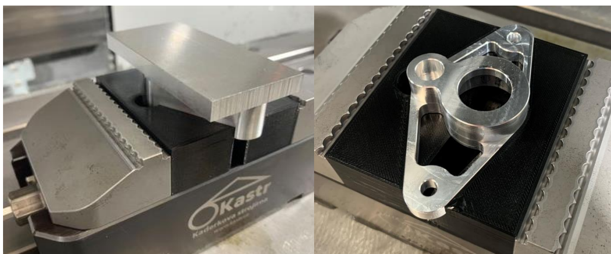
Obr. 47: Zleva upnutí do vyrobeného přípravku, díl po obrobení druhé strany
