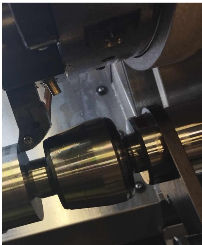
Obr. 55 Kontrola kolize nástroje s koníkem
