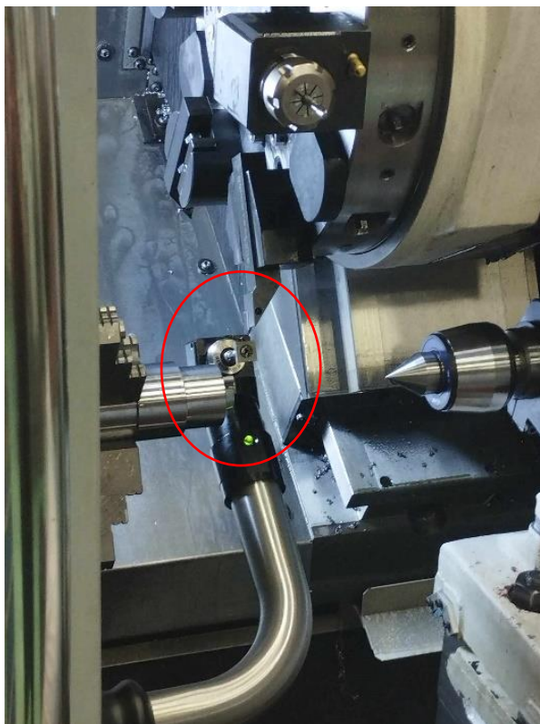
Obr. 51 Korekce nástrojů pomocí nástrojové sondy
