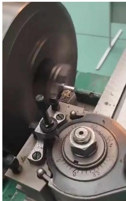
Obr. 53 Výroba kolíčku na univerzálním soustruhu
