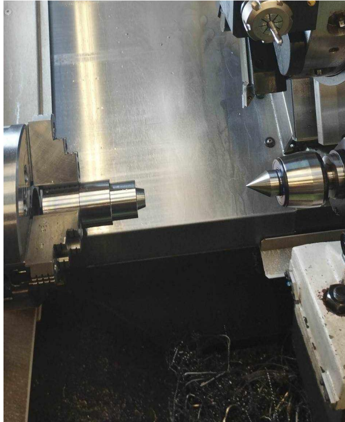
Obr. 52 Obrobená funkční část přípravku
