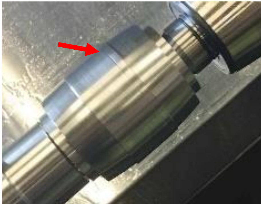
Obr. 57 Zajetí nástroje do technologického přídavku
