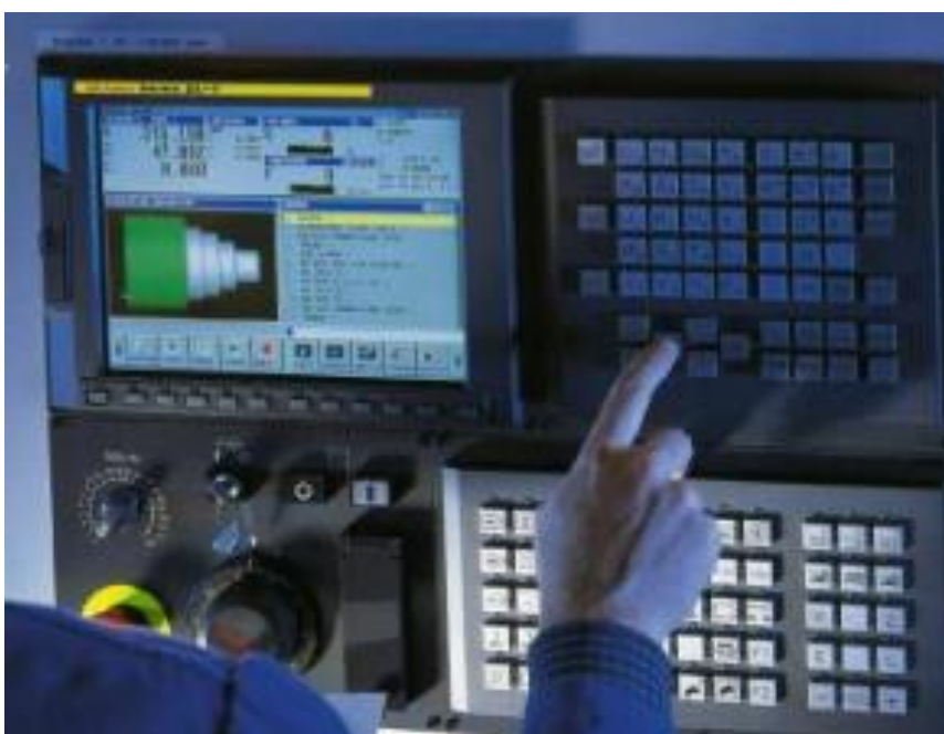
Obr. 22 Programování přímo na stroji
