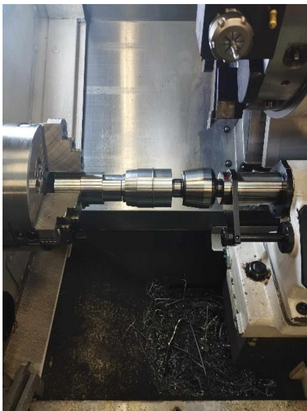
Obr. 54 Upnutí kladky na přípravek
