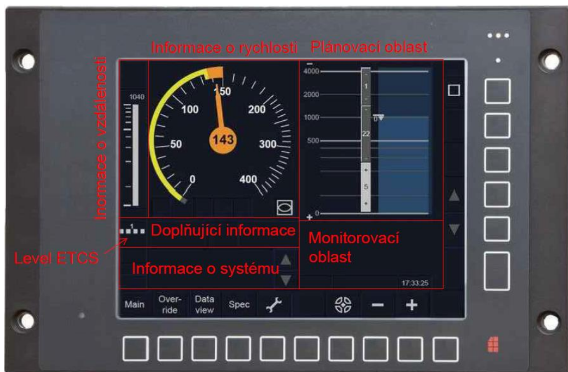
Obrázek 26 - Displej MMI [57], úprava autor práce
