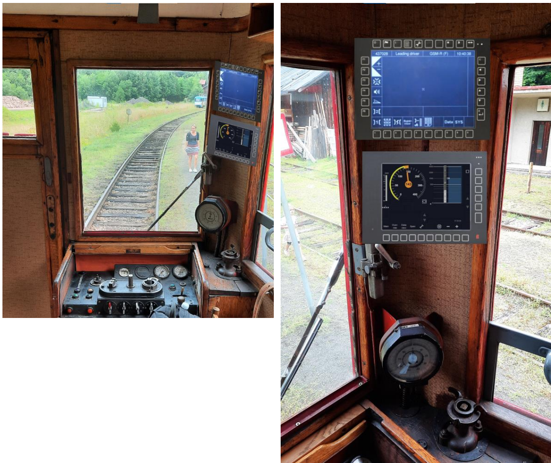
Obrázek 46 - Návrh umístění radiostanice GSM-R a multifunkčního displeje MMI, návrh a foto autor práce
