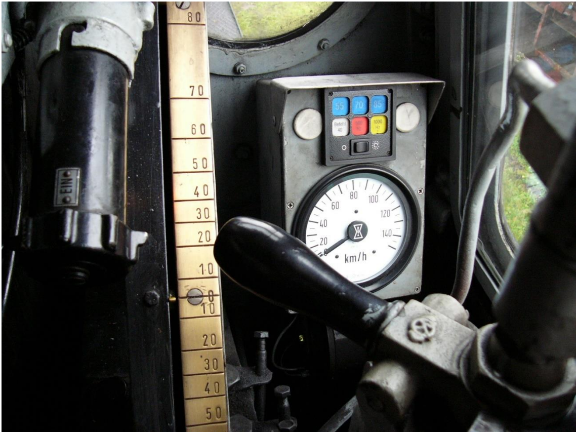
Obrázek 35 - Zabudovaný systém PZB s rychloměrem na parní lokomotivě [62]
