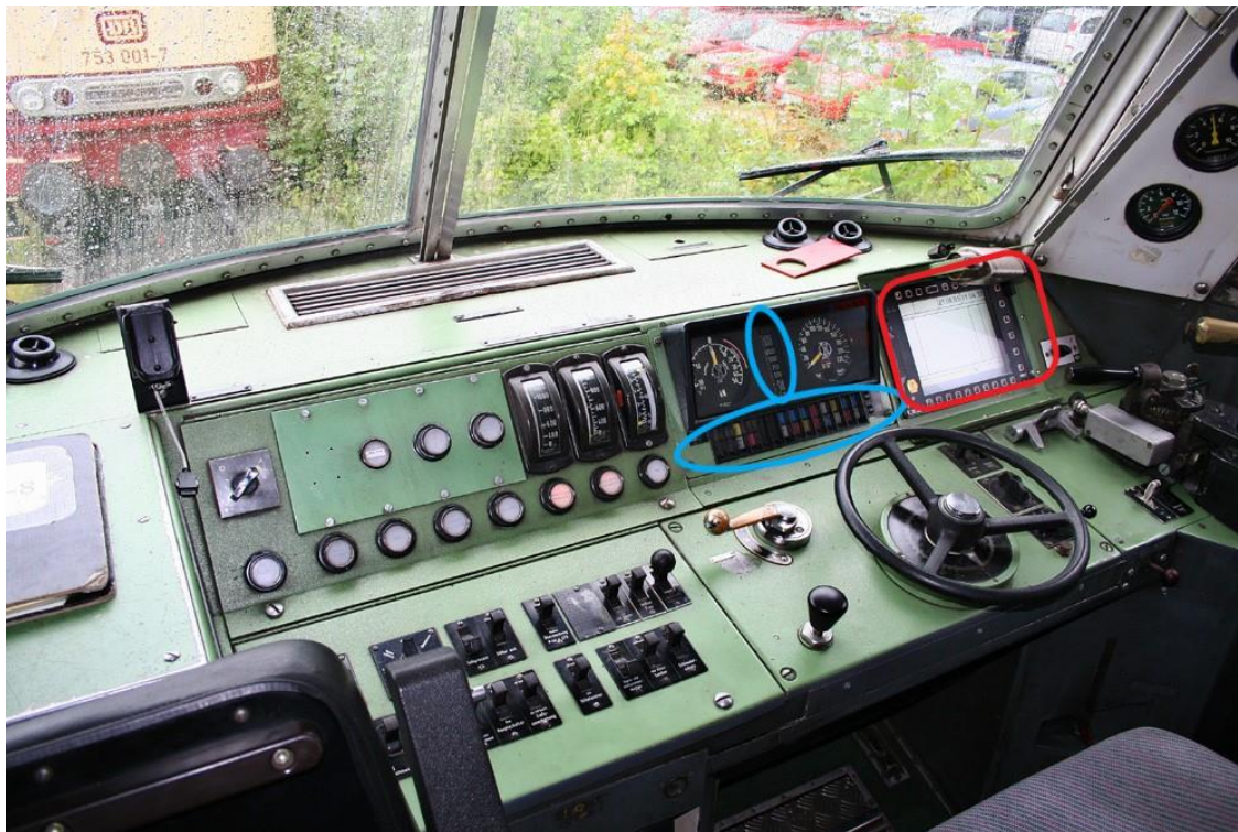
Obrázek 37 - Stanoviště lokomotivy řady 103 se zabudovaným systémem LZB a EBUla, úprava autor práce [64]
