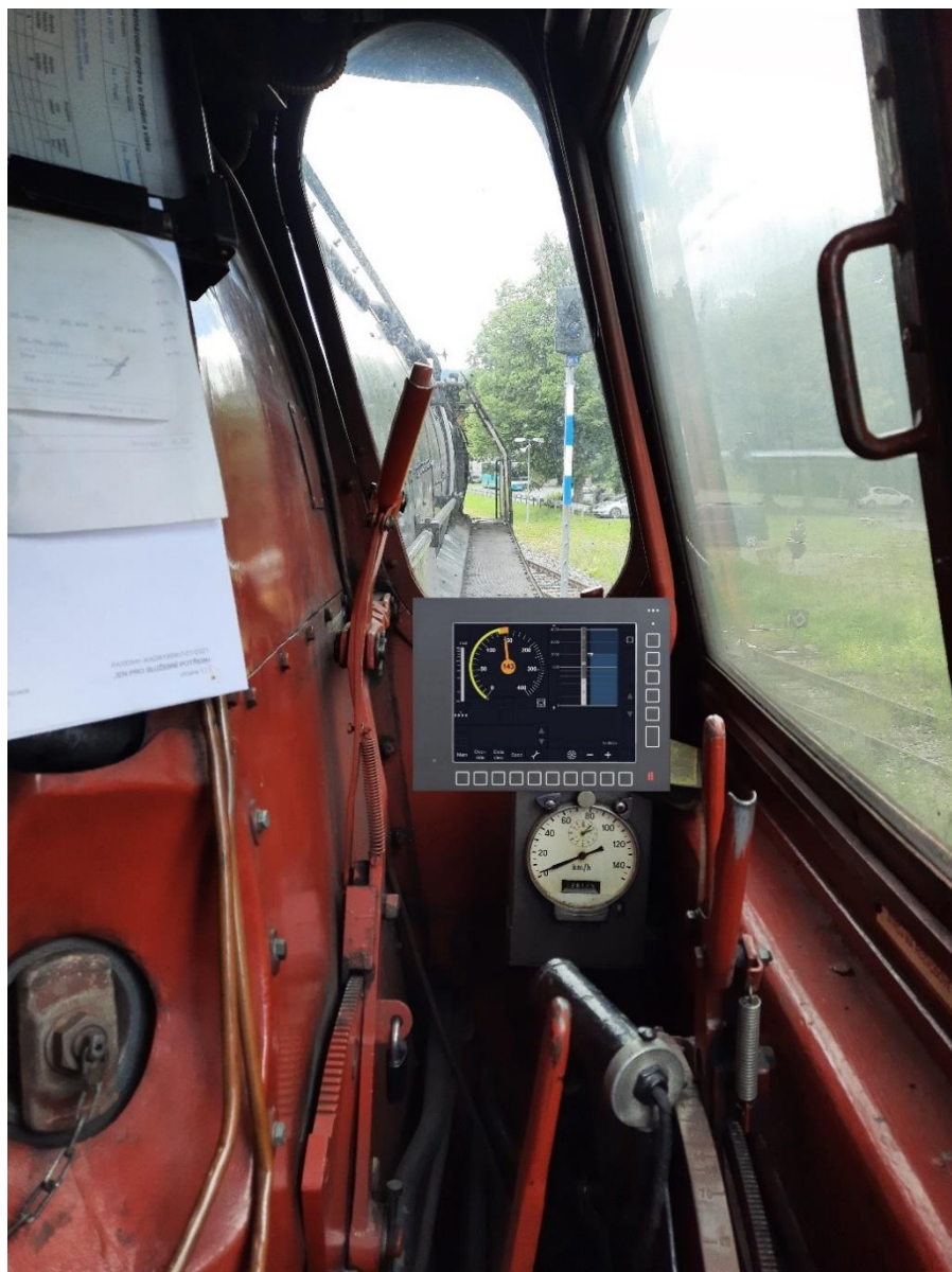
Obrázek 43 - Vizualizace možného umístění multifunkčního displeje MMI na stanovišti parní lokomotivy řady 475.1, foto i návrh autor práce, [57]
