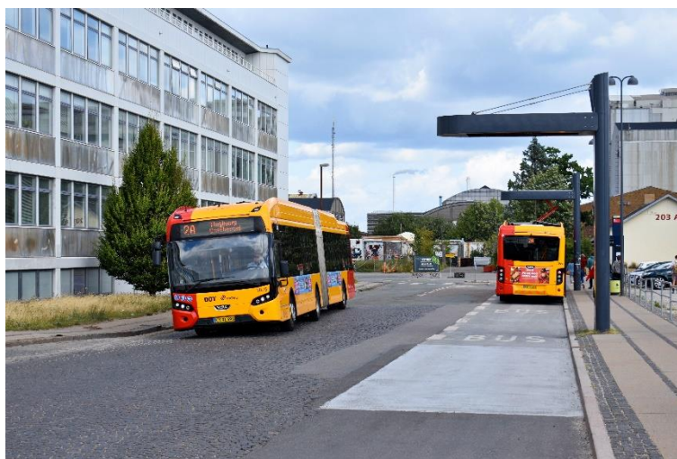
Obr. 4 Dvojice elektrobuses VDL Citea a dvě rychlonabíječky v přístavní části Kodaně. (foto: Matěj Stach)
