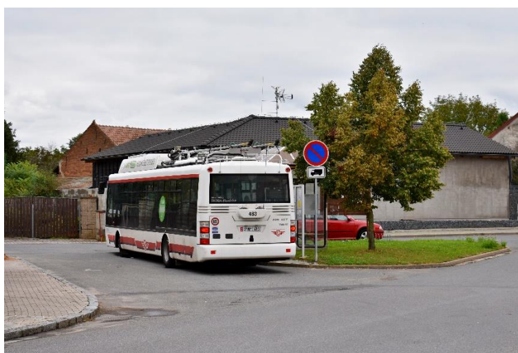
Obr. 1 Technologie tzv. parciálního trolejbusu v Pardubicích v praxi. Místo autobusů jezdí na lince 12 trolejbusy až do Úhřetic, které leží 9 km od centra města. (foto: Matěj Stach)
