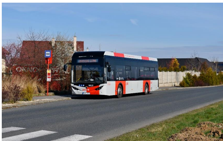
Obr. 8 Jeden z nových pražských elektrobusů Škoda 36 BB E'CITY na zkušební jízdě. (foto: Matěj Stach)
