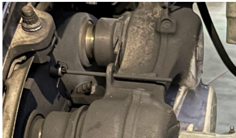
Obrázek 4 – Indicator pin značící zbývající obložení lamel brzděče
