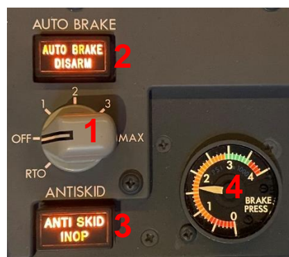
Obrázek 9 – Ovládání systému Autobrake v kokpitu, Zdroj: Autor
