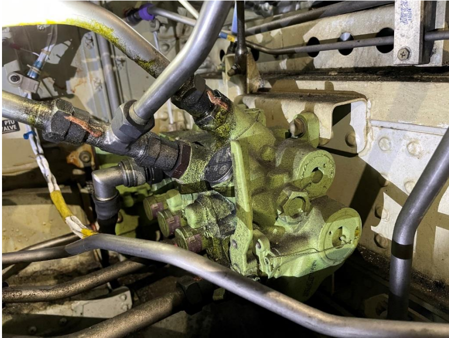
Obrázek 13 – Ventil ovládání T/R na motoru 2 znázorněný v Příloze 1, Zdroj: Autor
