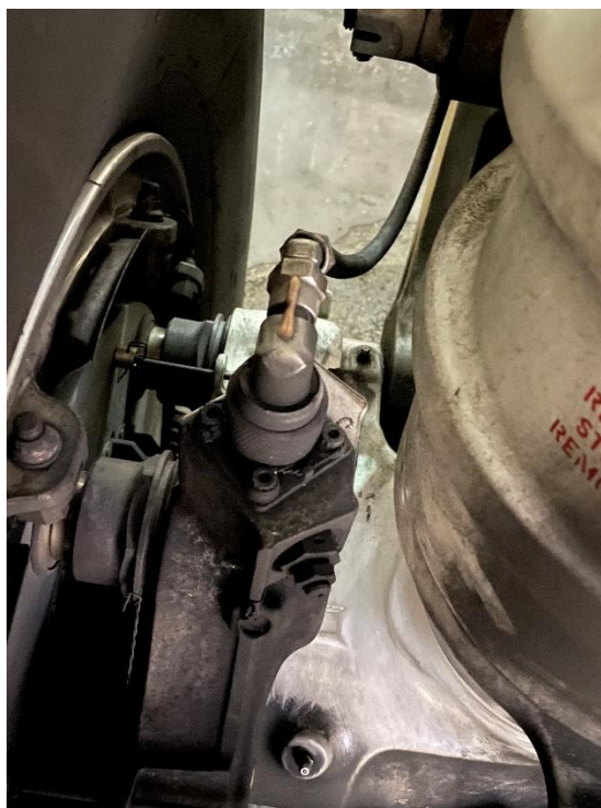
Obrázek 1 – Detail připojení brzděče k hydraulickému okruhu, Zdroj: Autor
