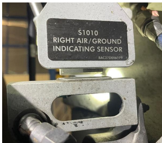
Obrázek 10 – Senzor indikující letadlo ve vzduchu/na zemi, Zdroj: Autor
