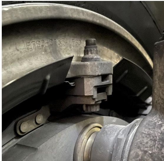
Obrázek 3 – Detail spojení kola se statorovými lamelami brzděče, Zdroj: Autor
