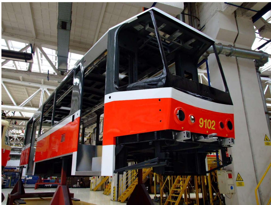
Obrázek 6 – Pohled na čelní článek z rozpojeného vozidla KT8D5 při probíhající opravě, rozpojování článkových tramvají na jednotlivé sekce za účelem údržby je běžnou a proveditelnou záležitostí [43]
