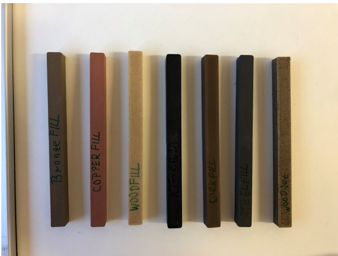
Obrázek 26 Fotografie zkušebních vzorků některých z testovaných materiálů
