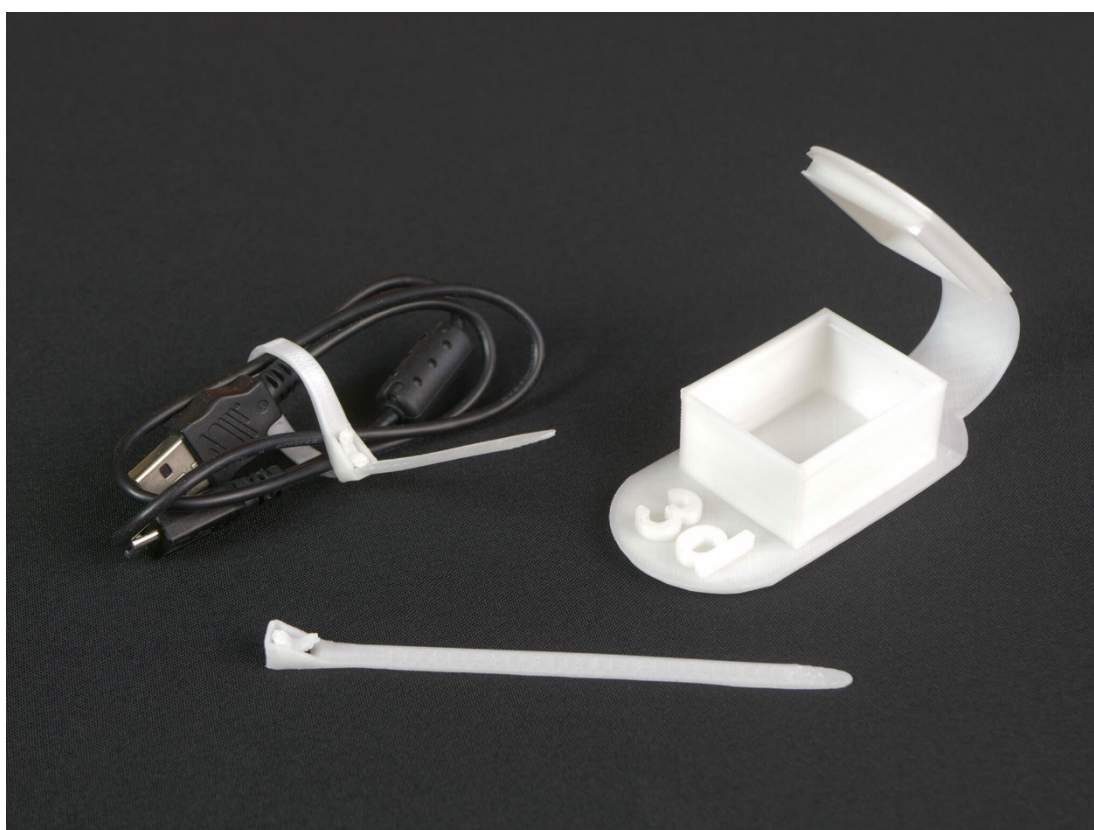
Obrázek 11 - Tisk ohebných dílů z materiálu Nylon PA
