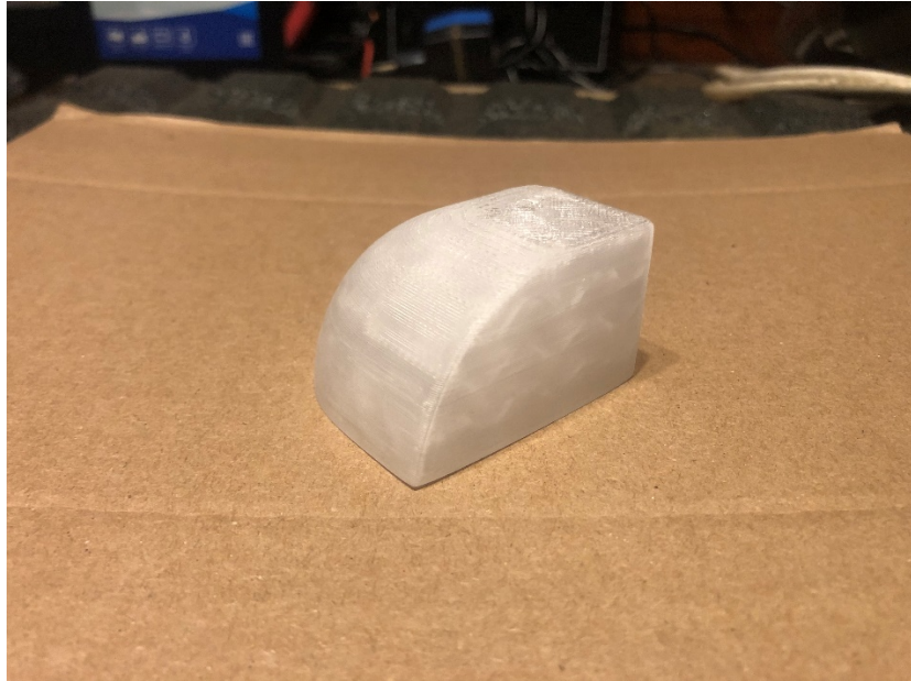
Obrázek 37 Výsledek broušení materiálu PMMA
