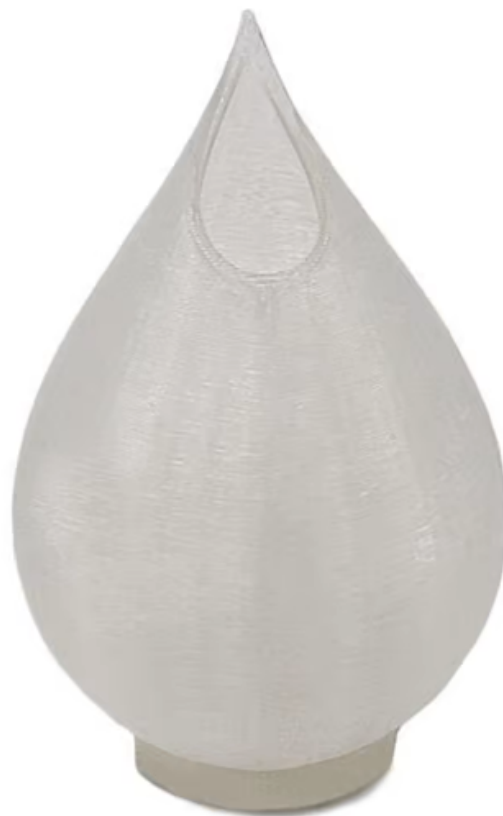
Obrázek 21 - Příklad tisku z materiálu PMMA [40]
