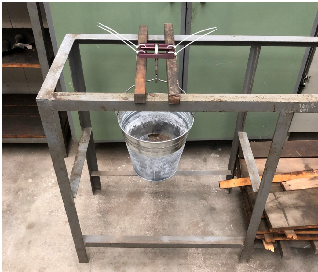
Obrázek 24 Fotografie nosné konstrukce pro zkoušku nosnosti
