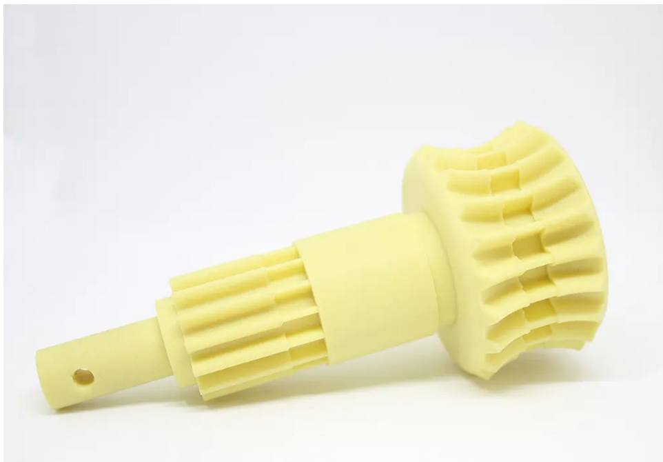
Obrázek 17 - Příklad výtisku materiálu Nylon AF80 Aramid [30]
