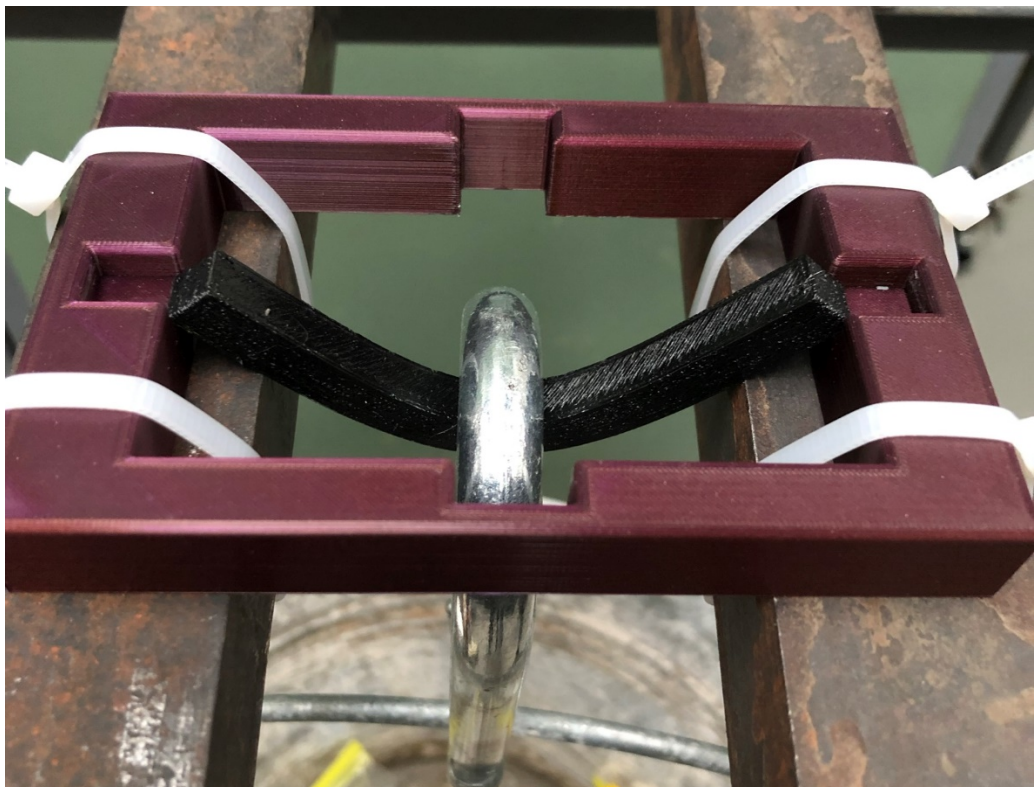
Obrázek 38 materiál FLEXFill 98A při zatížení
