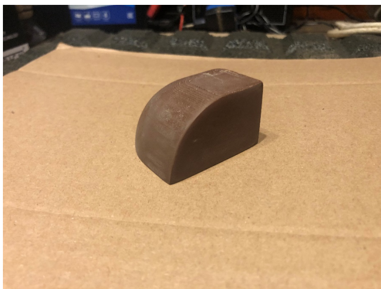
Obrázek 32 Výsledek broušení materiálu CORKFILL
