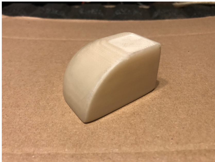
Obrázek 36 Výsledek broušení materiálu NonOilen
