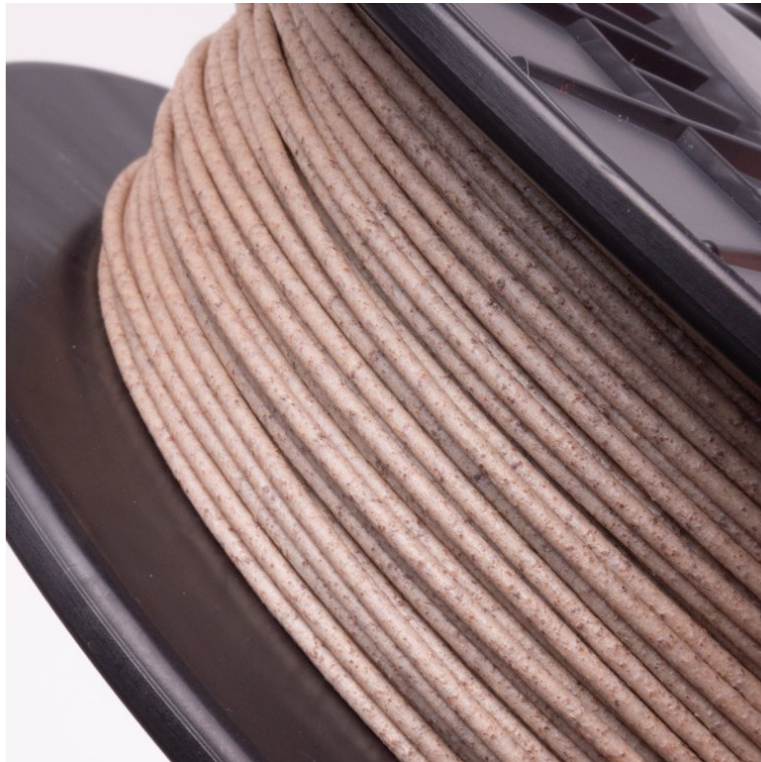
Obrázek 16 - Viditelné částice plniva v materiálu WOODJet [29]
