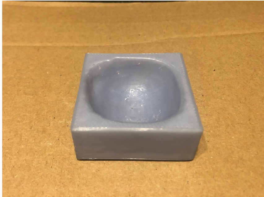
Obrázek 41 Příklad vyhlazení povrchu nahřívací pistolí materiálu MoldLay
