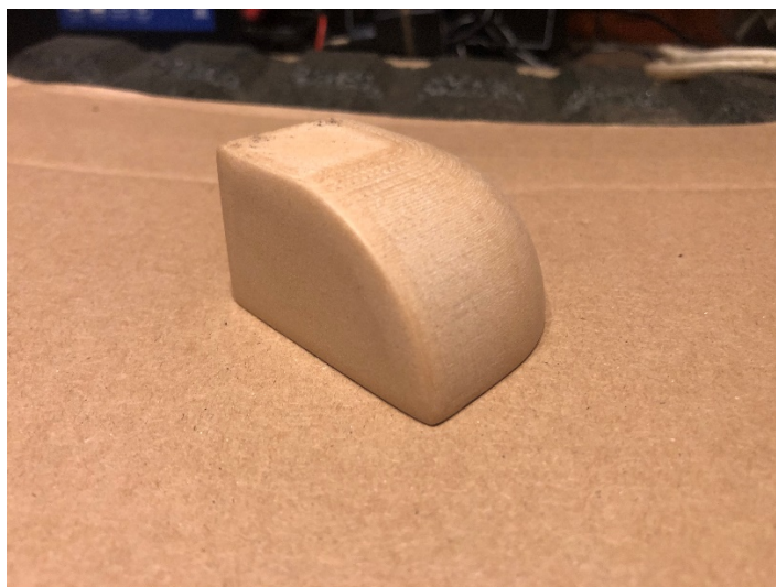
Obrázek 31 Výsledek broušení materiálu WOODFILL
