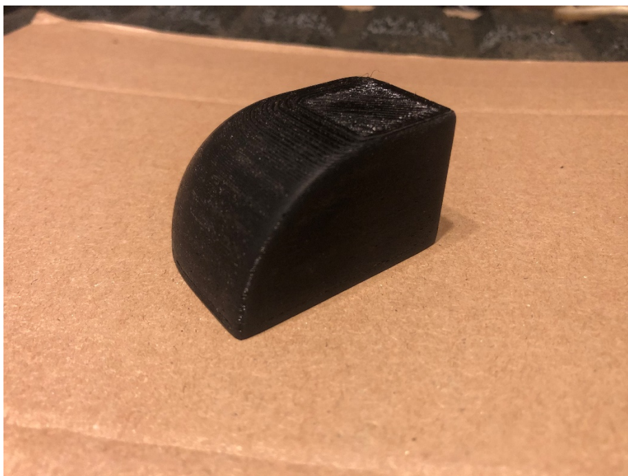
Obrázek 40 Výsledek broušení materiálu FLEXFil 98A
