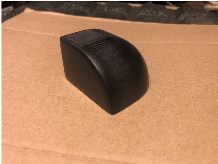
Obrázek 34 Výsledek broušení materiálu XT-CF20
