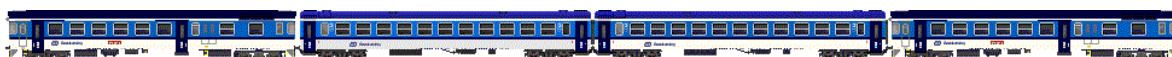
Obrázek 21 Souprava složená z motorového vozu 854, 2 vozů Bdtn a motorového vozu 854 pravidelně řazená na spěšných vlacích v ŽST Lužná u Rakovníka dopravcem České dráhy a.s. (zdroj: [75])
