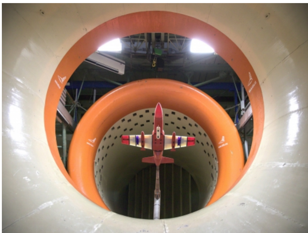
Obr. 1.1: Testování modelu letounu L-39 NG v aerodynamickém tunelu
