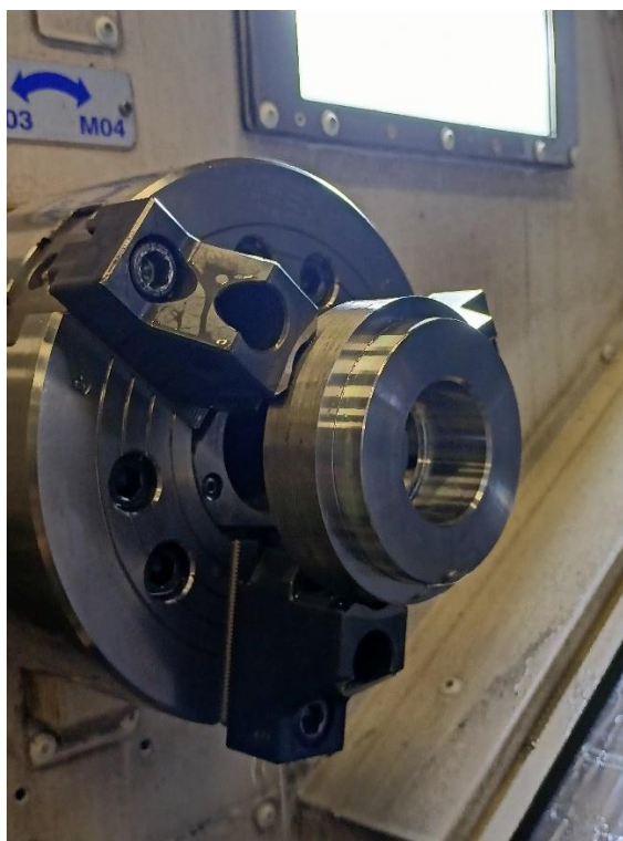
Obrázek 24: Výsledný tvar po prvním upnutí
