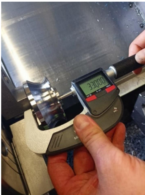
Obrázek 41: Kontrola šířky součástky v tvrdém stavu
