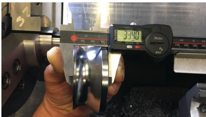
Obrázek 33: Kontrola šířky v měkkém stavu
