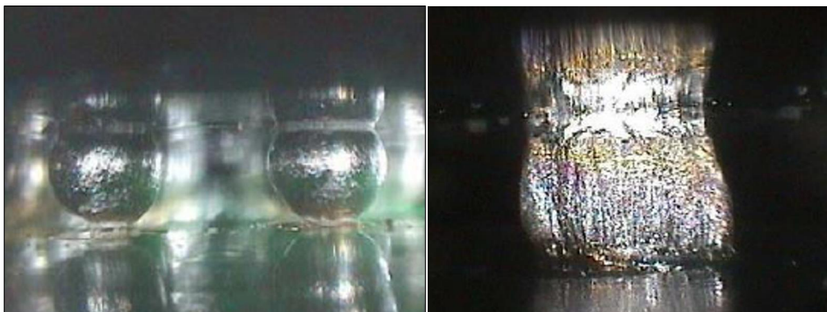
Obr. 5: BGA vývody, vliv vhodně zvoleného teplotního profilu na připájení vývodů
