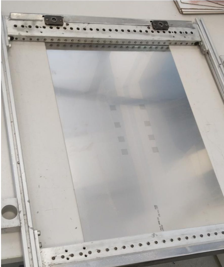
Obr. 18: Nerezová šablona pro nanesení pájecí pasty
