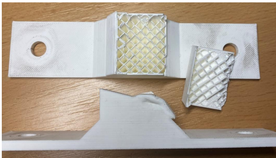
Obrázek 47 Deformace nástrojů s 20 % infillem. Nahoře infill typu mřížka, dole infill typu triangle
