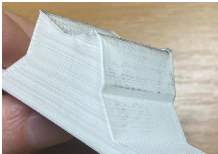
Obrázek 50 Deformace nástroje s infillem typu mřížka
