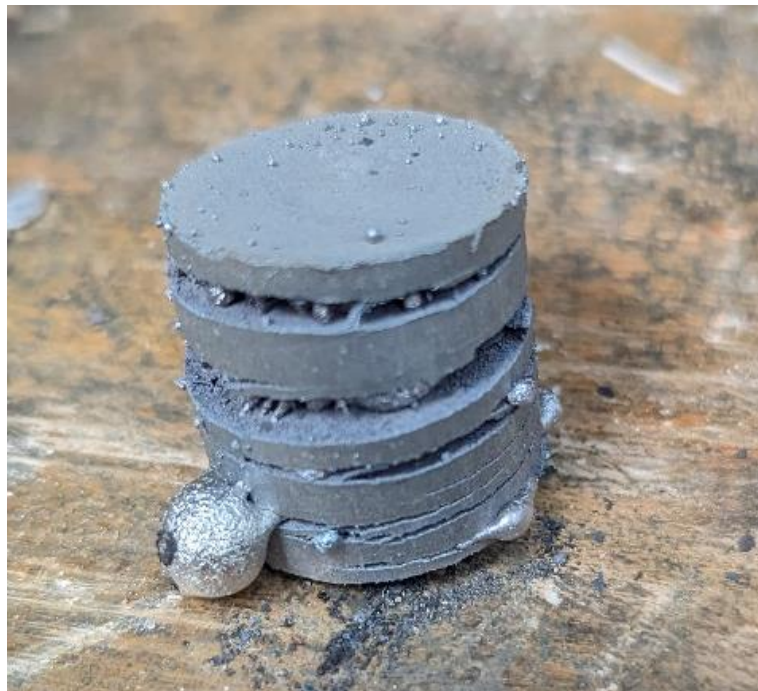
Obr. 51 Napěnění "rozlámaného" vzorku \varnothing 25 z materiálu AlSi10Mg [Zdroj: vlastní]
