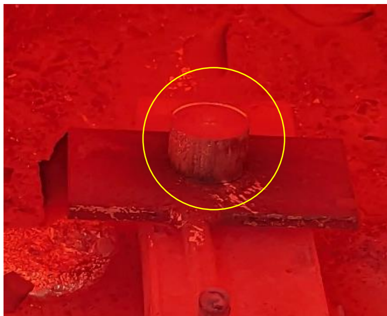
Obr. 40 Vzorek po 2 minutách v peci při 720°C [Zdroj: vlastní]
