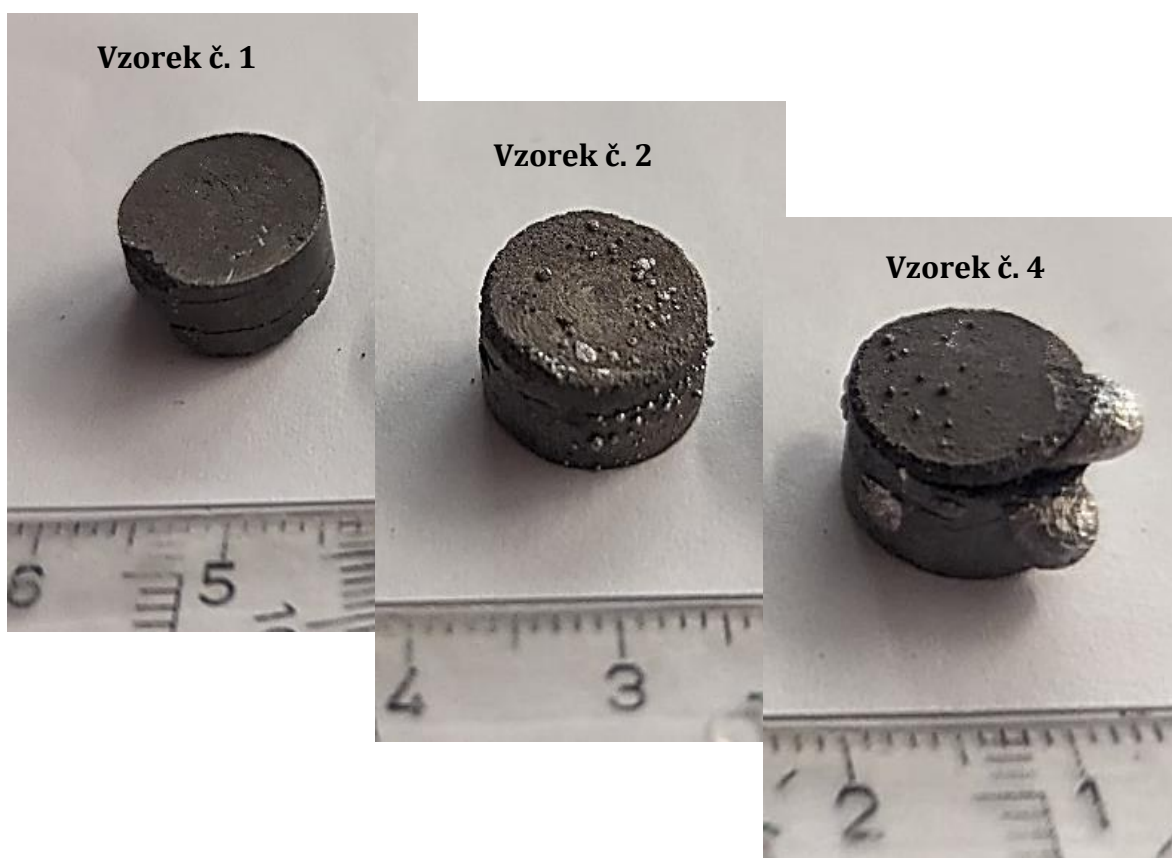
Obr. 28 Vzorek č. 1, 2 a 4 po fázi "pěnění" [Zdroj: vlastní]
