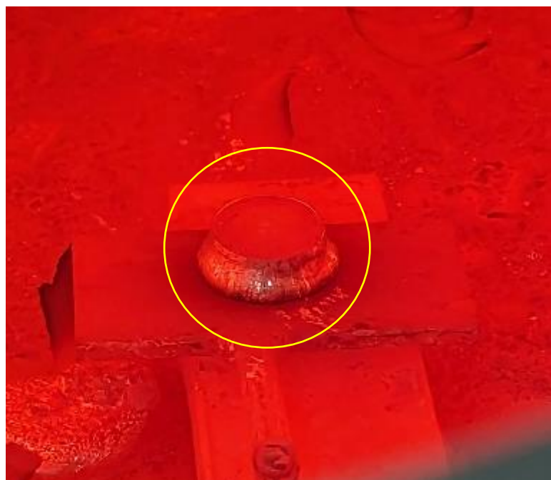
Obr. 41 Vzorek v peci při 720°C po 4 minutách [Zdroj: vlastní]
