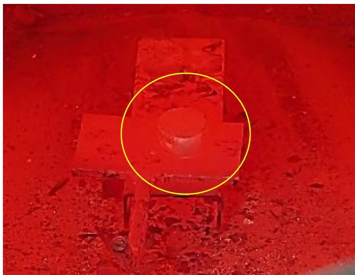
Obr. 30 Žíhací pec se vzorkem č.10 po 6 minutách při 680°C [Zdroj: vlastní]
