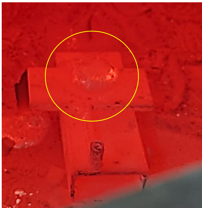
Obr. 44 Vzorek v peci při 720°C po 10 minutách [Zdroj: vlastní]
