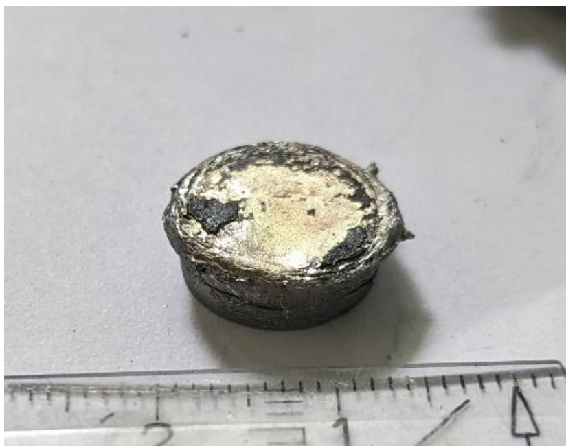
Obr. 31 Vzorek č.13 po zhroucení pěnové struktury [Zdroj: vlastní]
