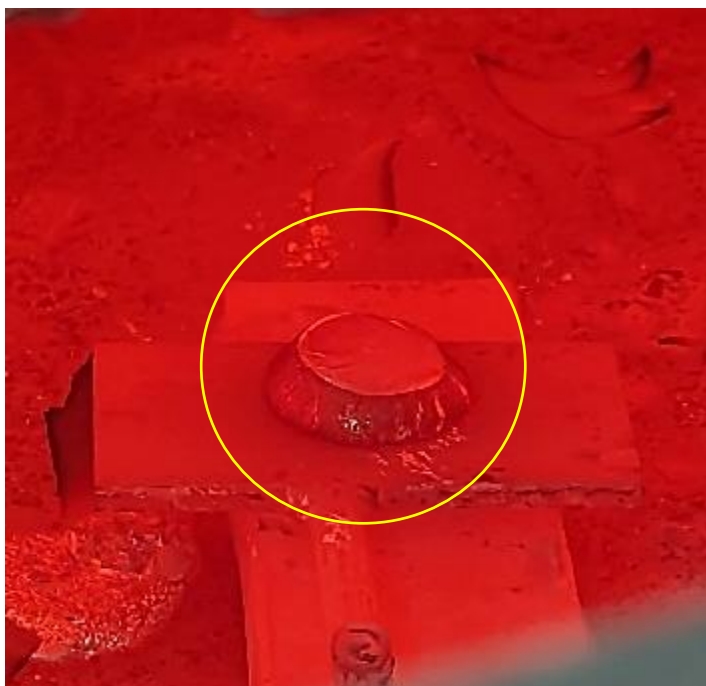
Obr. 42 Vzorek v peci při 720°C po 6 minutách [Zdroj: vlastní]
