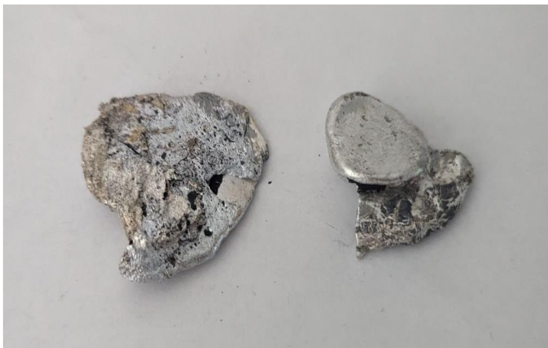
Obr. 45 Totální destrukce vzorků [Zdroj: vlastní]
