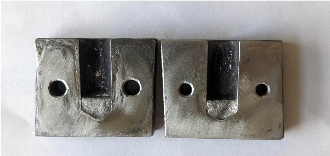
Obr. 22 Lisovací forma po první pokusu lisování [Zdroj: vlastní]
