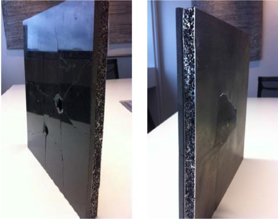
Obr. 3 Vrstvený panel z 8mm silné leštěné granitové desky a 20mm silný pěnový sendvič z hlikové slitny po zasažení projektilem [8]
