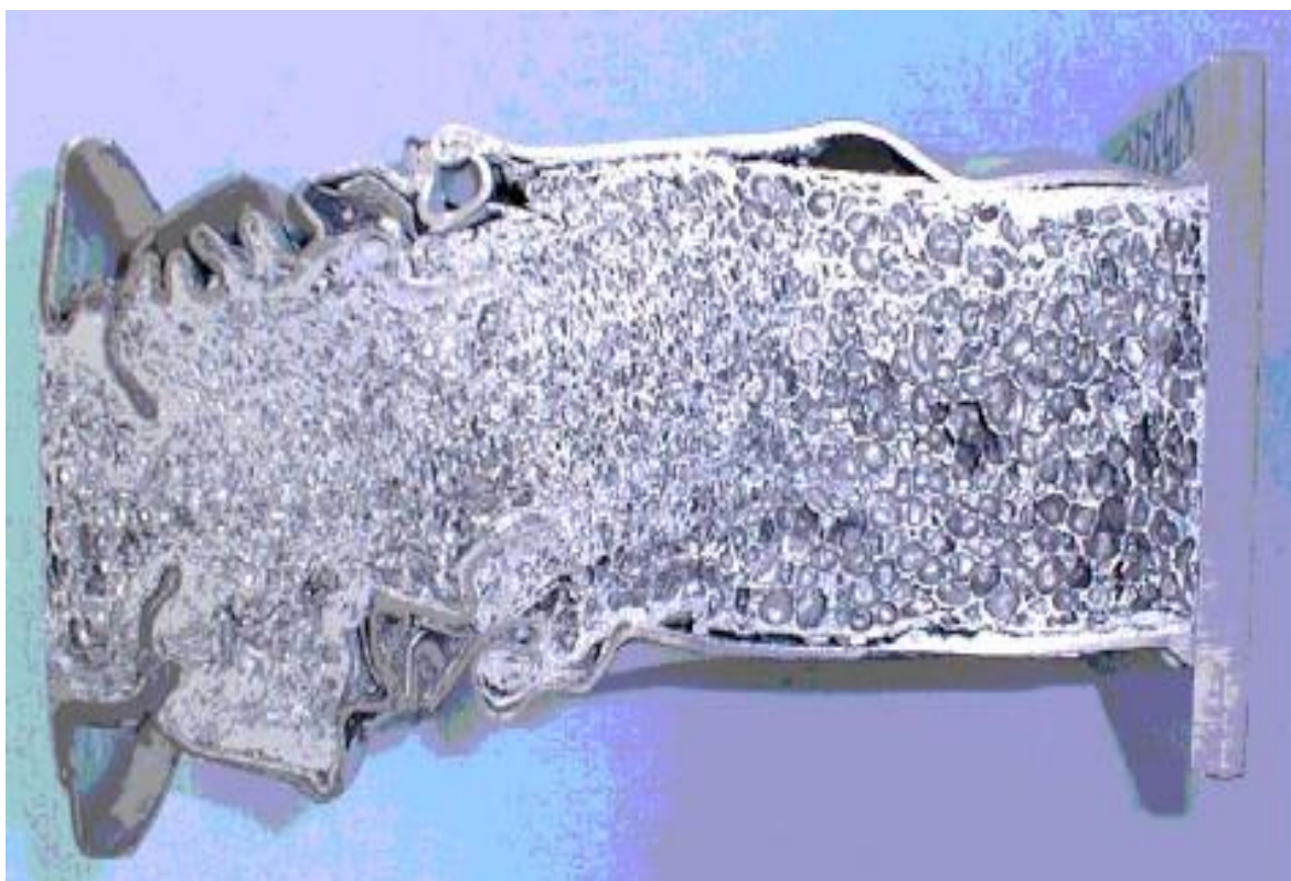
Obr. 14 Řez nosníku motoru vyplněný Alulight pěnou po čelním nárazu [13]
