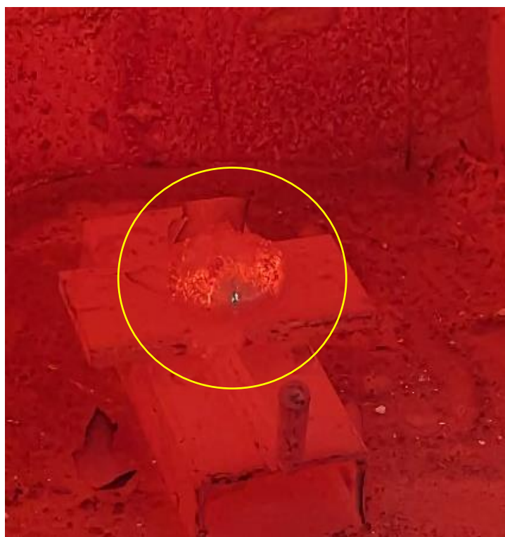
Obr. 43 Vzorek v peci při 720°C po 8 minutách [Zdroj: vlastní]
