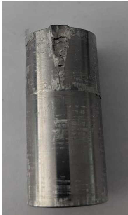
Obr. 37 Poškozený trn \varnothing 24\text{mm} [Zdroj: vlastní]
