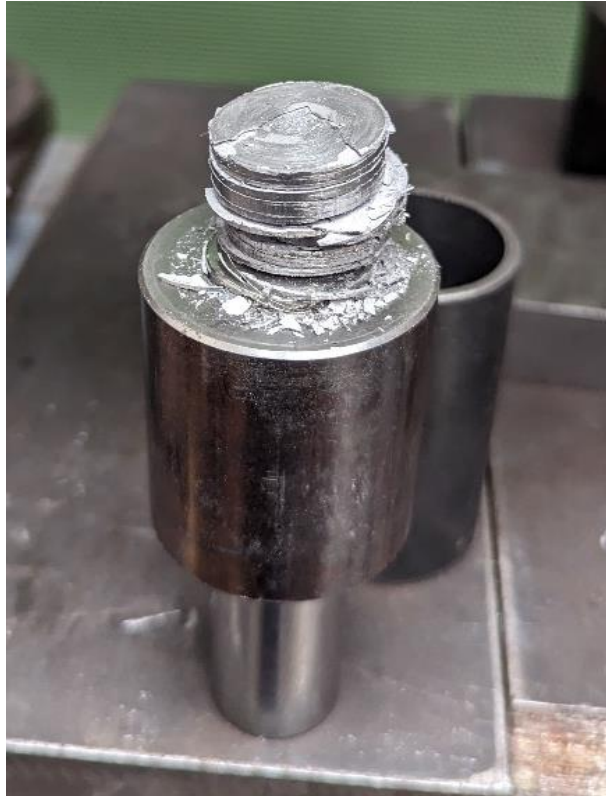
Obr. 50 Vylisování vzorku \varnothing 25 z materiálu AlSi10Mg [Zdroj: vlastní]
