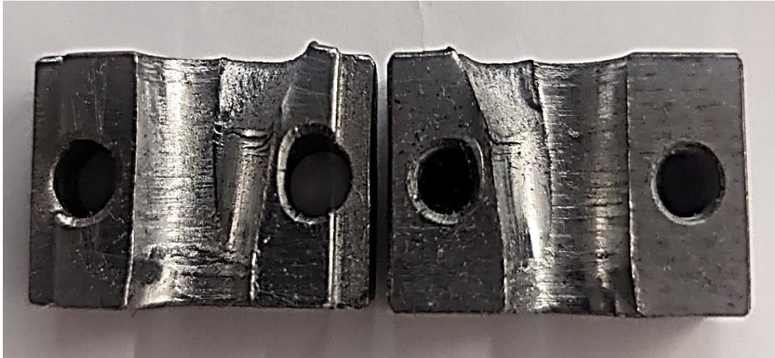
Obr. 24 Upravená první verze lisovací formy (zdeformovaná po lisovacím pokusu) [Zdroj: vlastní]
