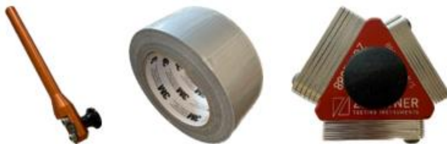
Obrázek 36: Zkušební pomůcky pro provedení mřížkové zkoušky [foto autora práce]
