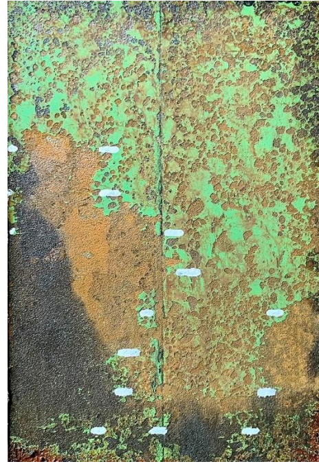
Obrázek 49: Vzorek IR (4) pro hodnocení stupně delaminace [foto autora práce]
