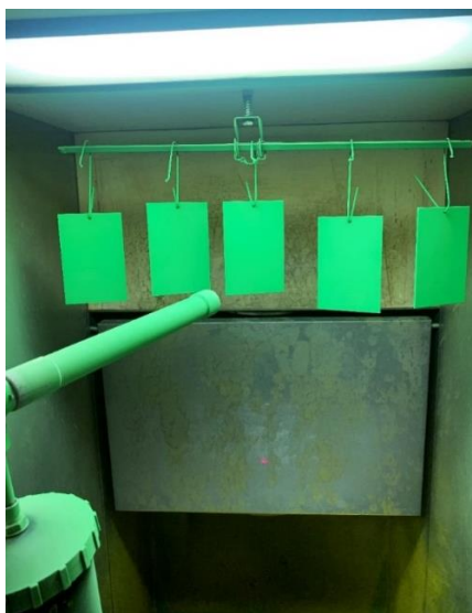
Obrázek 34: Elektrostatické nanášení pomocí tribostatického náboje [foto autora práce]
