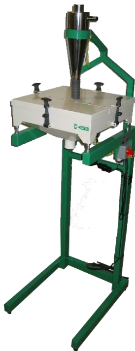
Obrázek 4: Zařízení pro čištění prášku - je určeno pro pneumatickou dopravu práškové barvy přes cyklon v horní části zařízení. Prosátá barva spadává do odvětrávaného zásobníku umístěného pod prosévačkou. Většinou je použit přímo zásobník stříkáací techniky, nebo lze dodat včetně zásobníku. [9]
