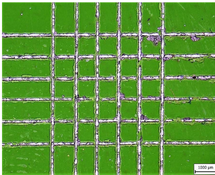
Obrázek 38: Vzorek IR (3); zoom 1,2; hodnocení zkoušky 2 [foto autora práce]
