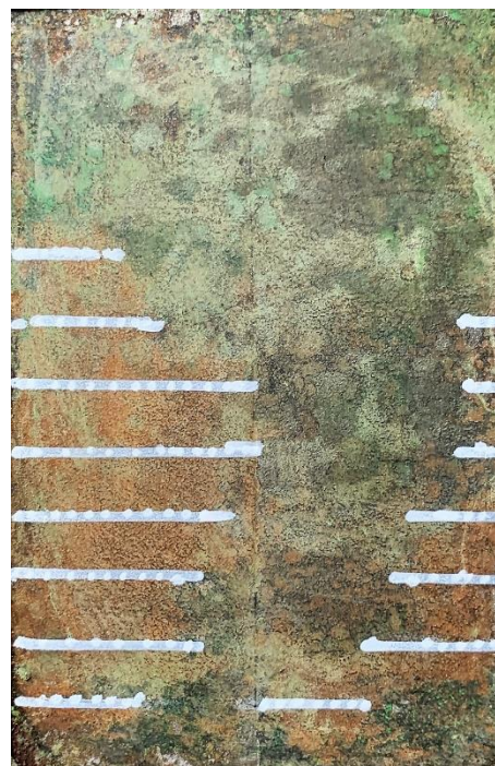
Obrázek 51: Vzorek IR (4) pro hodnocení koroze v okolí řezu [foto autora práce]
