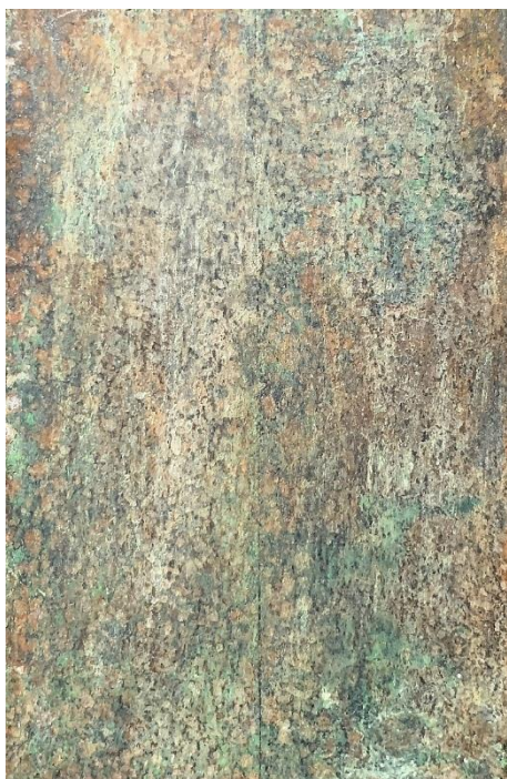
Obrázek 48: Vzorek HRK (4) pro hodnocení koroze v okolí řezu [foto autora práce]
