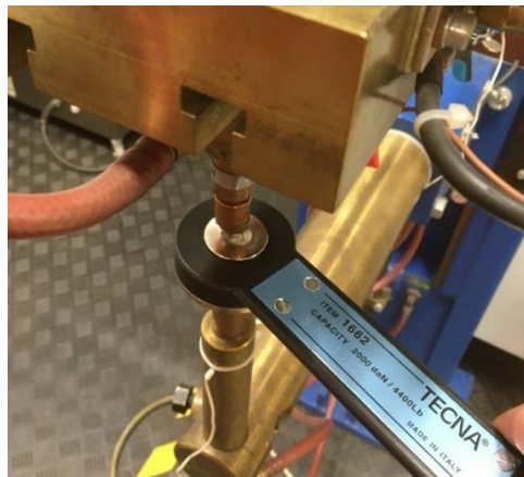
Obr. 17 - měření přitlačné síly pomocí snímače TECNA
