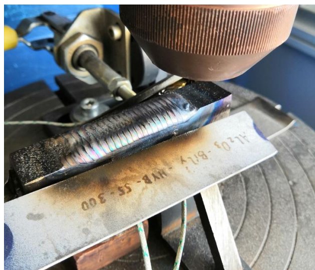
Obrázek 16 Metoda oscilačního navařování
