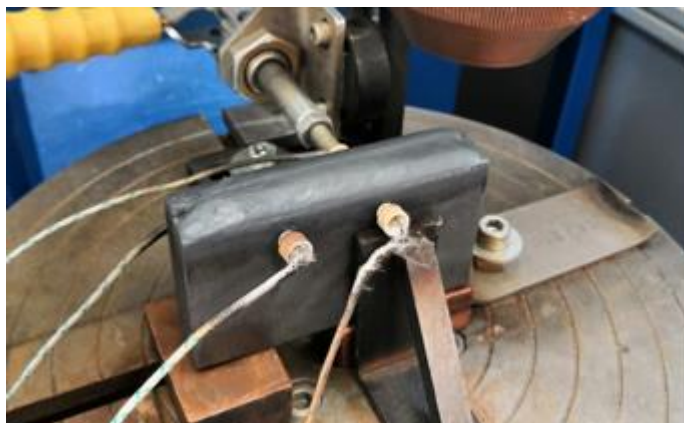
Obrázek 13 Termočlánky s keramickými kroužky
