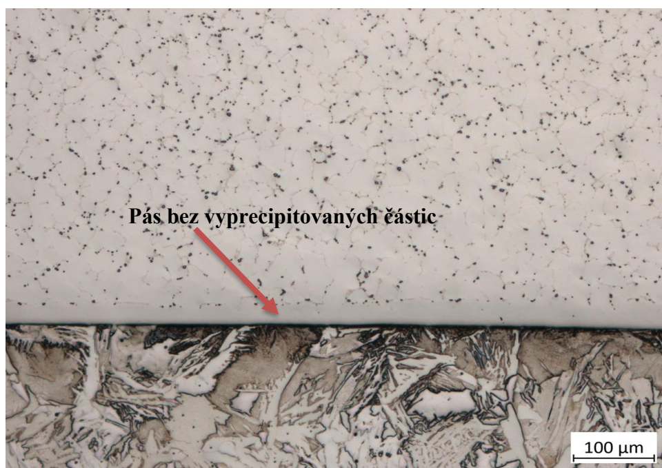
Obrázek 40 Pás bez částic u materiálu HSS 23, Zvětšení 100x
