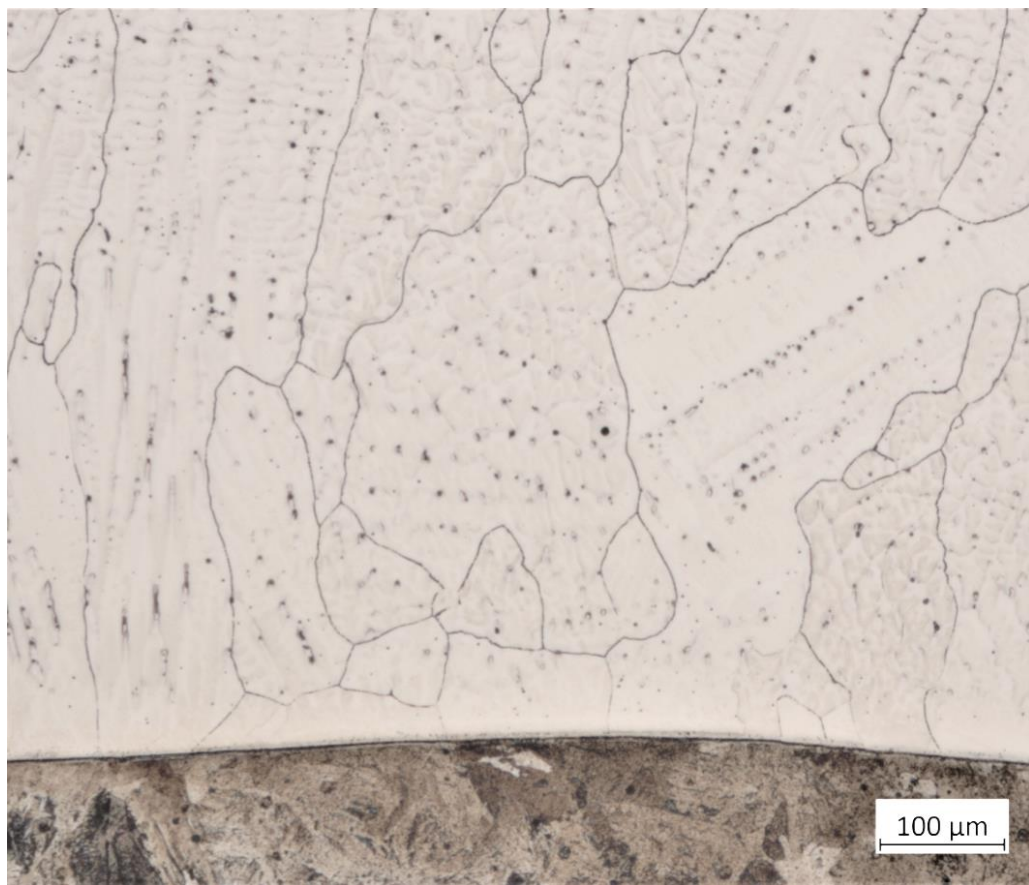
Obrázek 26 Hranice austenitických zrn oceli SZW 5049, Zvětšení 100x
