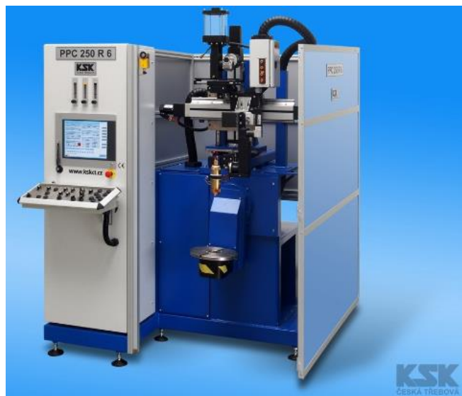
Obrázek 6 Plazmový navařovací automat PPC 250 R6 [48]
