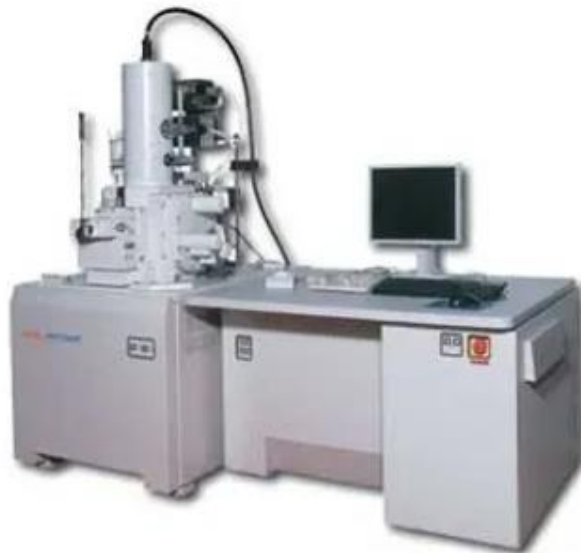
Obrázek 10 Elektronový mikroskop JSM-7600F [53]
