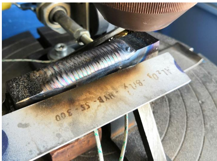
Obrázek 14 Termočlánky překryty destičkami
