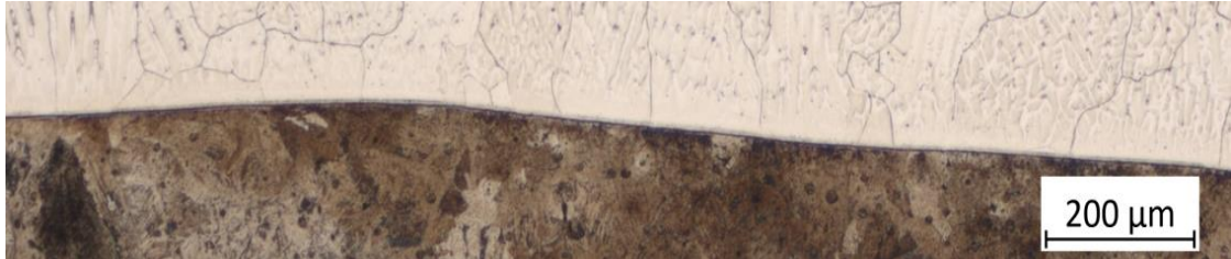
Obrázek 29 Metalurgické spojení oceli SZW 5049, Zvětšení 50x
