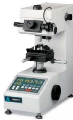
Obrázek 9 Tvrdoměr Buehler IndentaMet 1104 [52]
