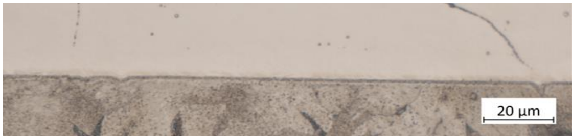
Obrázek 30 Metalurgické spojení oceli SZW, Zvětšení 500x
