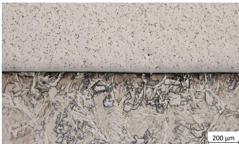
Obrázek 38 Metalurgické spojení oceli HSS 23, Zvětšení 50x
