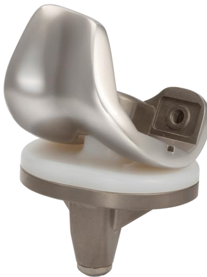
Obr. 1 Kloubní implantát s femorální částí vyrobenou z CoCrMo, tibiální částí z TiAl 6 V 4 a s UHMWPE tibiální vložkou. [12]
