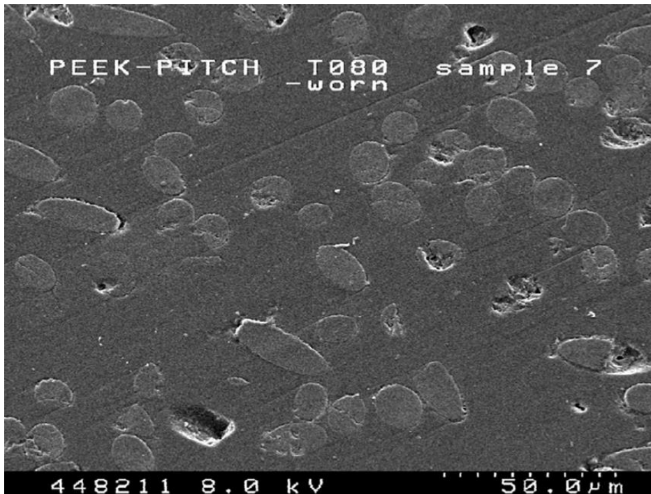
Obr. 6 Povrch opotřebovaného vzorku CFR-PEEK testovaného in-vitro. [8]
