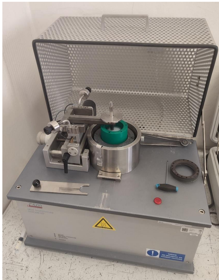
Obr. 16 Tribometr HTT od společnosti CSM Instruments. Vzorek je upnut v zeleném přípravku, kde je zároveň ponořen do fyziologického roztoku PBS.
