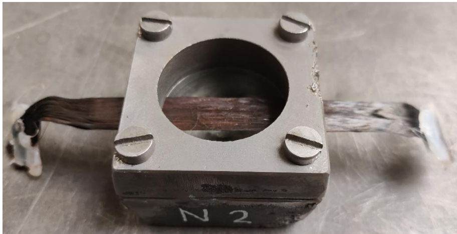
Obr. 24 Kokila se založeným rovingem
