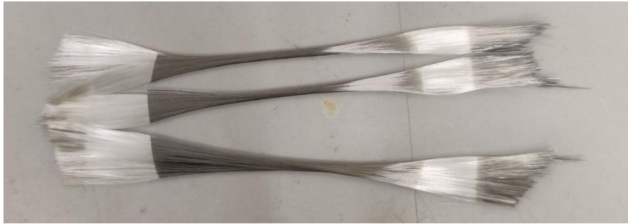
Obr. 21 Vzorky poniklované metodou PVD
