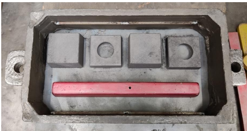
Obr. 16 Uložení modelu a vtokového kanálu do formovacího rámu
