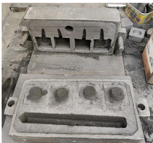
Obr. 17 Písková forma po vyjmutí modelu kokily
