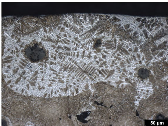
Obrázek 55: Detail zakaleného povrchu litiny EN-GJS-700 CuNi
