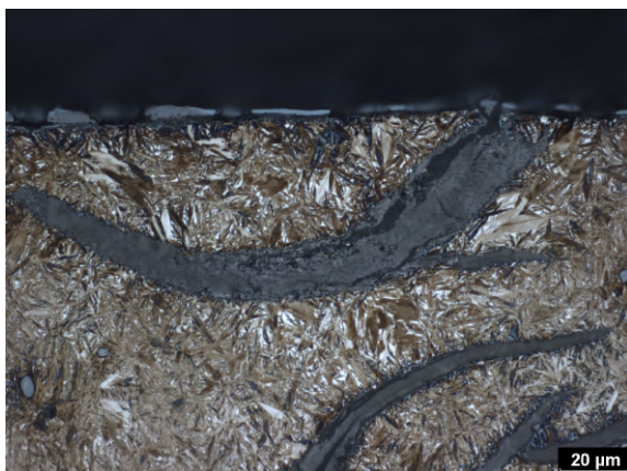
Obrázek 51: Detail zakaleného povrchu litiny EN-GJL-250 Sn
