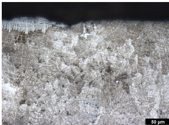
Obrázek 59: Detail kaleného povrchu litiny Extral-1A
