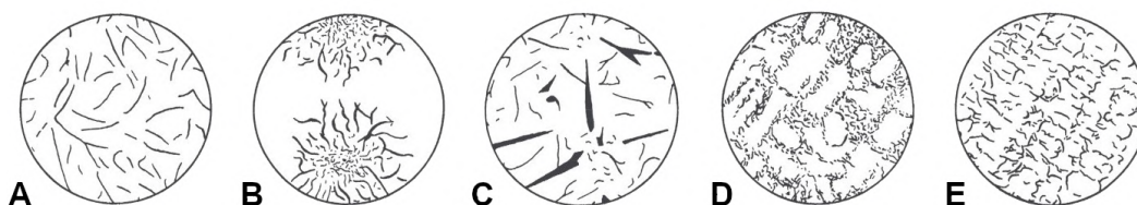
Obrázek 3: Rozložení lupínkového grafitu, upraveno autorem dle [7]
