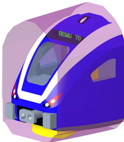
Obr. 29: 3D model čela v obálce obrysu pro konstrukci vozidla
