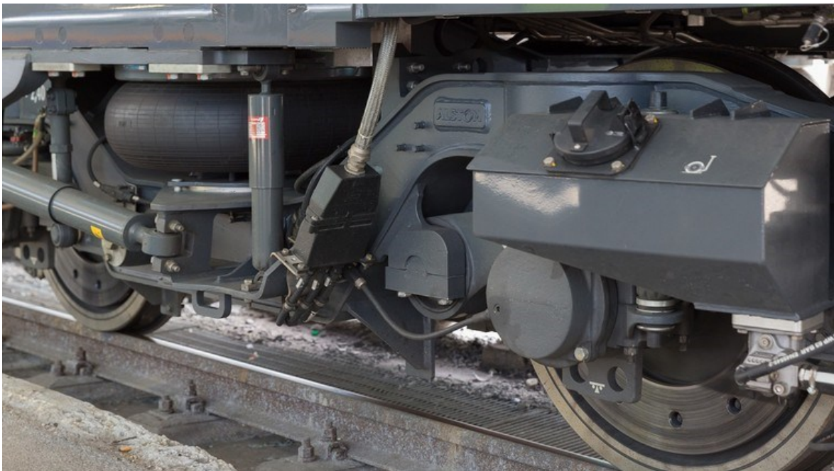
Obr. 18: Podvozek jednotky Alstom Coradia iLint [21]
