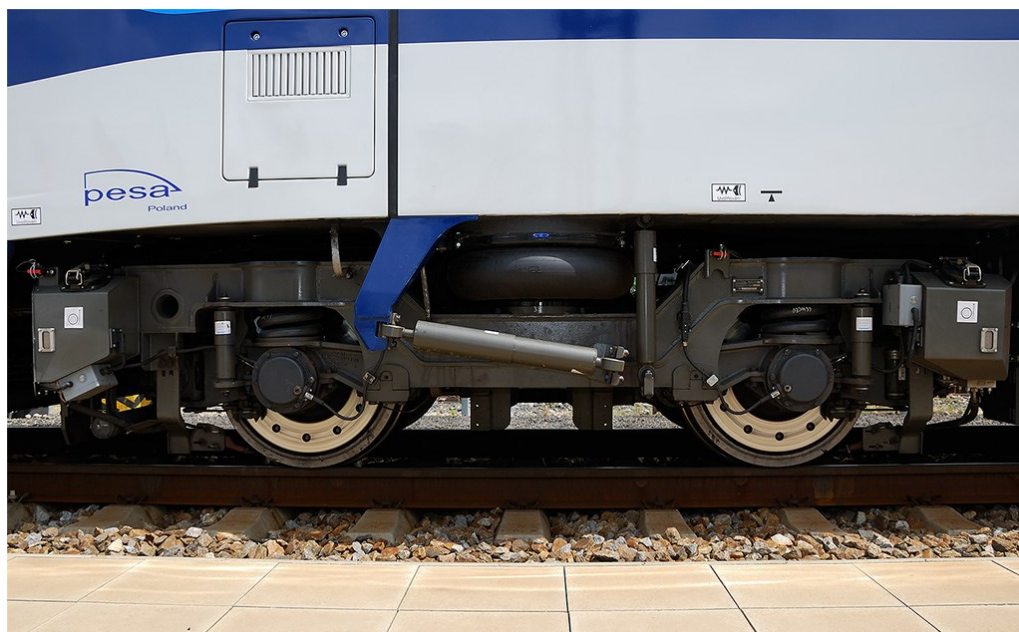
Obr. 9: Trakční podvozek motorových vozů Pesa Link [10]
