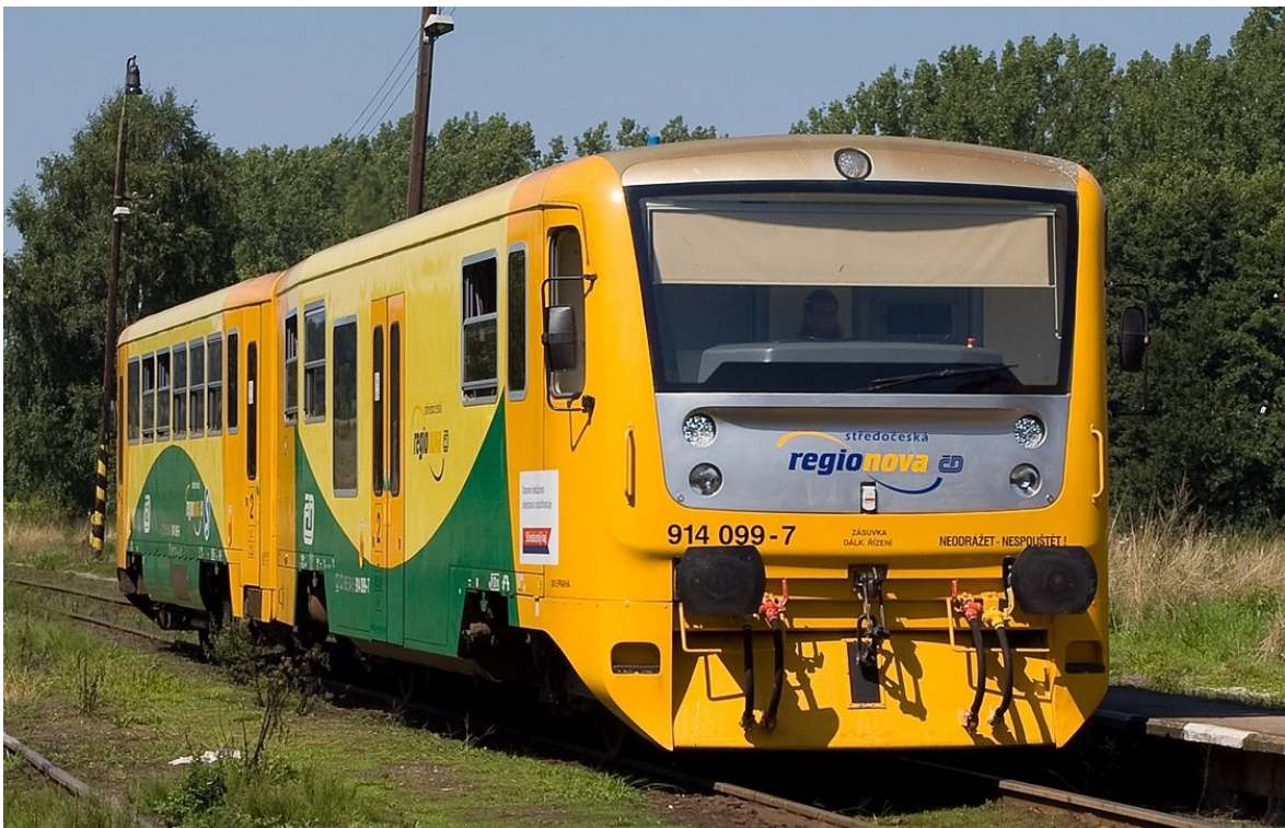
Obr. 1: Dvouvozová jednotka 814+914 Regionova [1]
