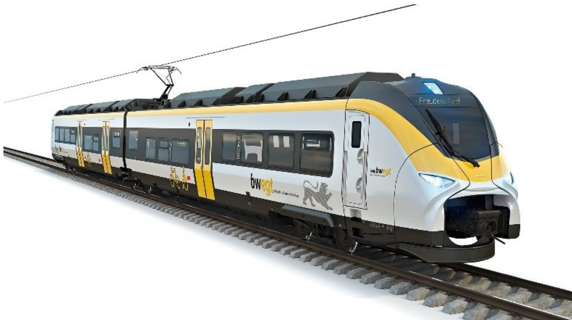
Obr. 19: Jednotka Siemens Mireo v provedení BEMU [23]
