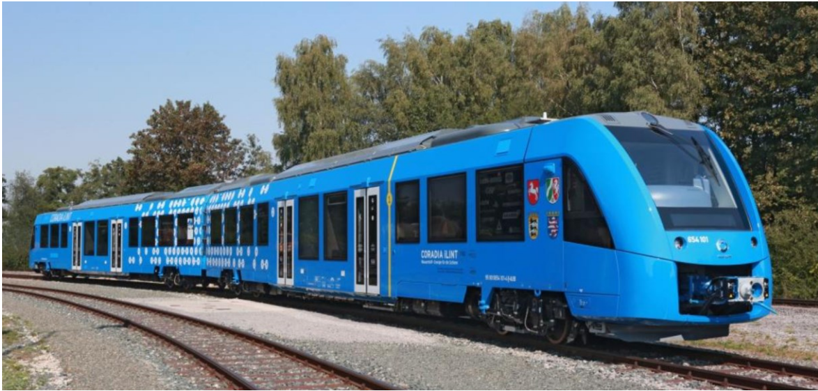
Obr. 16: Dvouvozová vodíková jednotka Alstom Coradia iLint [20]
