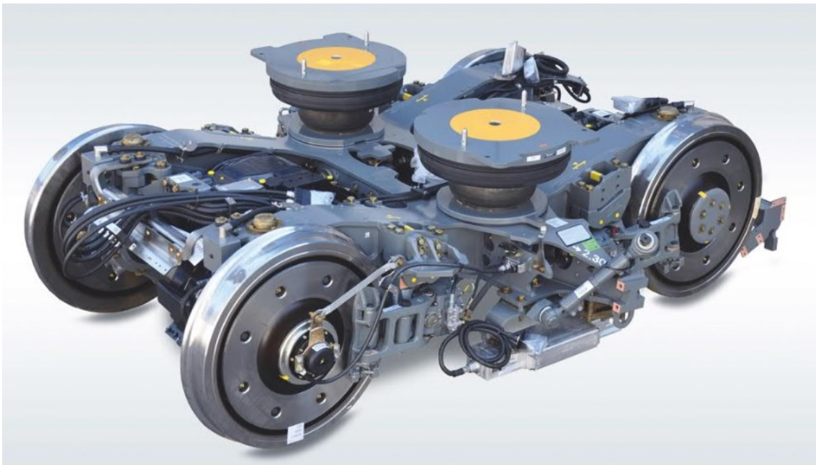
Obr. 21: Trakční podvozek SF7500 [24]
