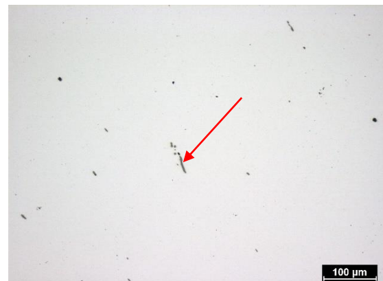
Obr. 28 Lamelární vměstek (vzorek C1)
