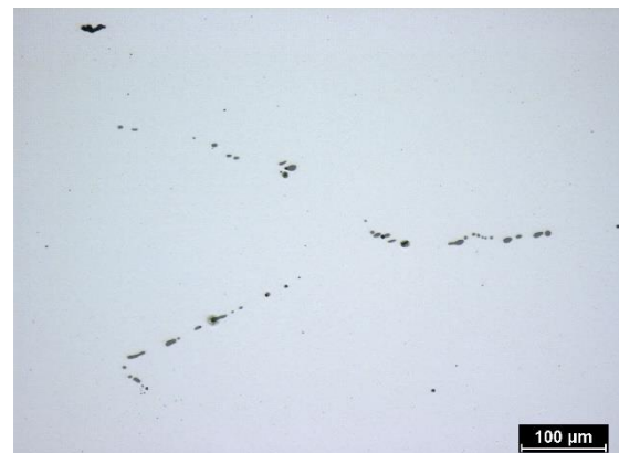
Obr. 31 Shluky vměstku podél hranic zrn (vzorek B2)
