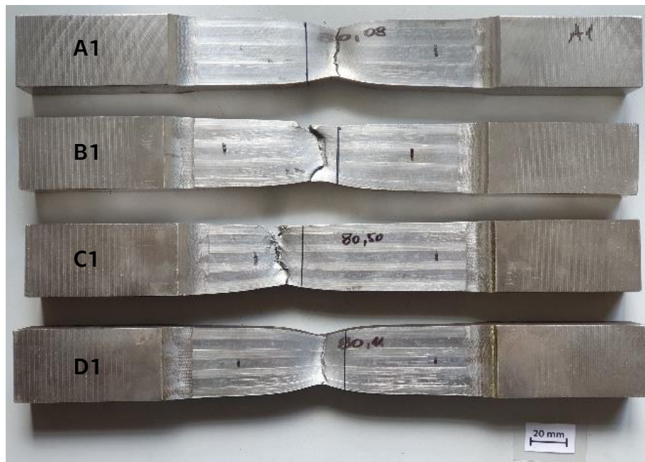
Obr. 12 Vzorky z oblasti 1 po zkoušce tahem
