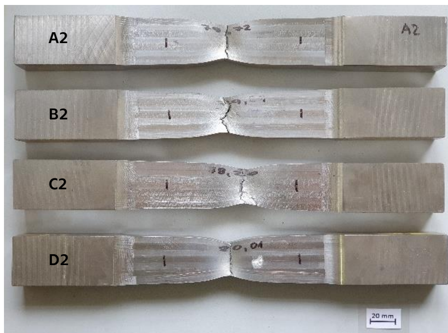
Obr. 13 Vzorky z oblasti 2 po zkoušce tahem
