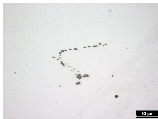
Obr. 22 Shluky po hranicích zrn (vzorek B1)
