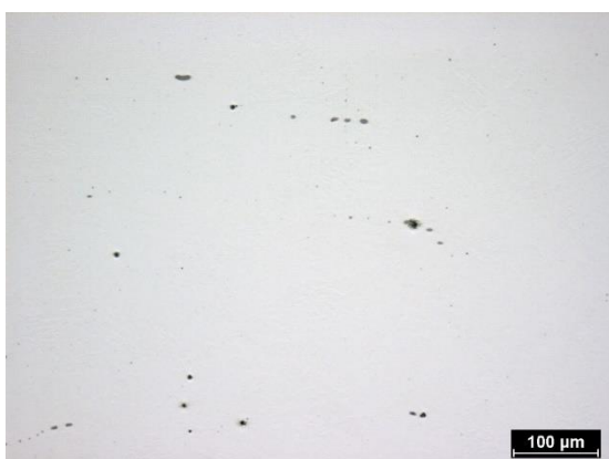
Obr. 21 Vměstky ve struktuře (vzorek B1)
