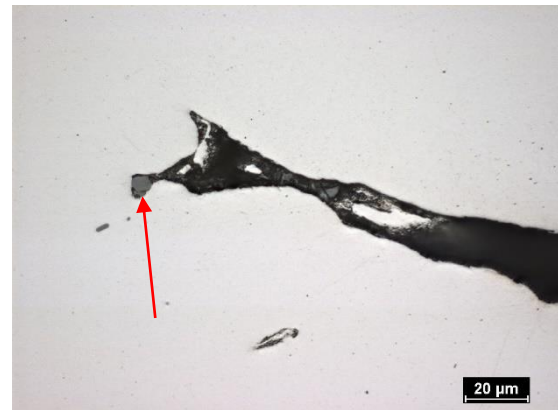
Obr. 26 Vměstek v dutině z obr. 25 (vzorek B1)
