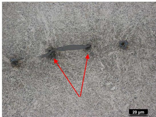
Obr. 33 Naleptaná struktura s dutinami okolo vměstků (vzorek B1)
