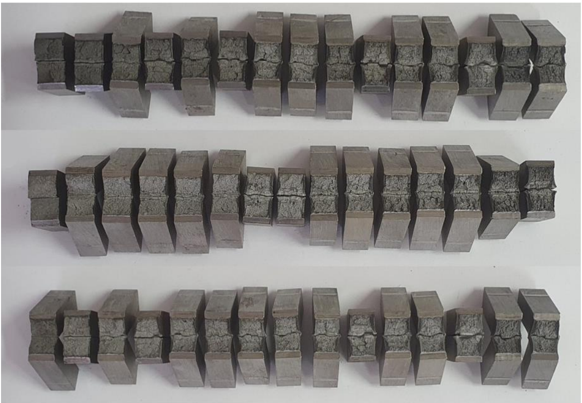
Obr. 15 Lomové plochy vzorků z oblasti 1 po zkoušce rázem v ohybu
