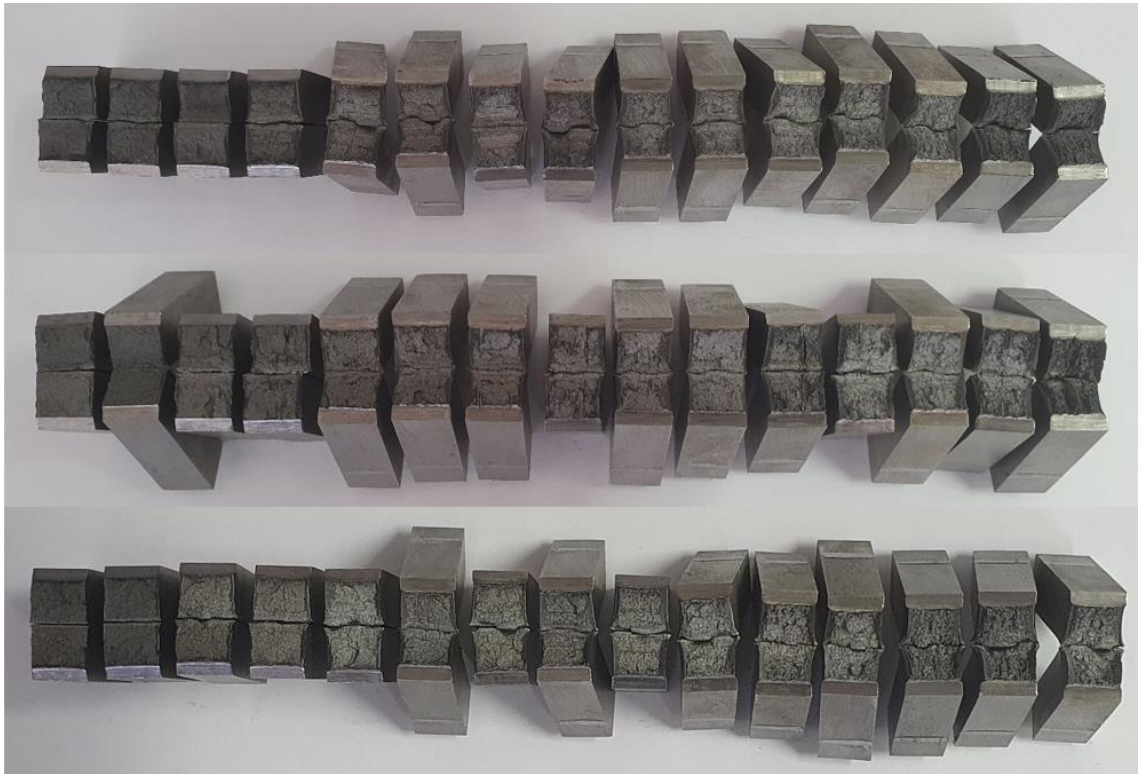
Obr. 15 Lomové plochy vzorků z oblasti 1 po zkoušce rázem v ohybu
