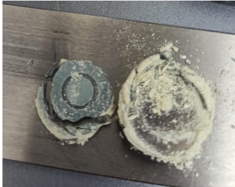
Obrázek 31: Porušení integrity vzorku RHEA-4N-1100
