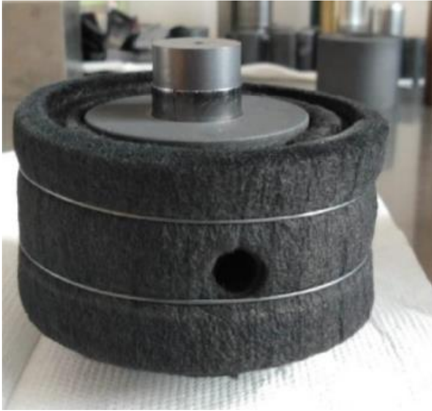
Obrázek 21: Grafitová zápustka s filcem
