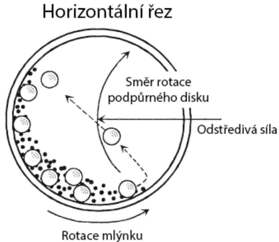
Obrázek 8: Schematické znázornění vnitřku mlecího mlýnku [22]
