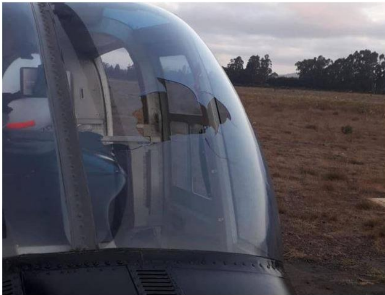
Obr. 10 Bell 206B po kolizi s dronem DJI Mavic Air 2 (Chile 2021) [23]
