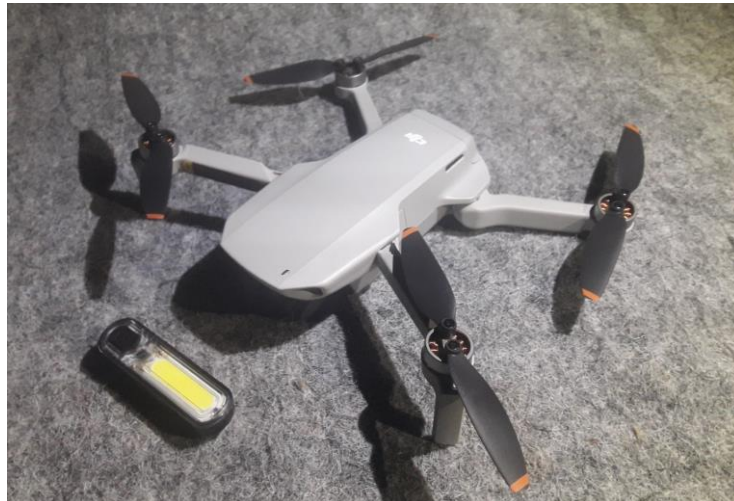
Obr. 13 Použité vybavení pro zkušební lety – DJI Mini II a zdroj světla
