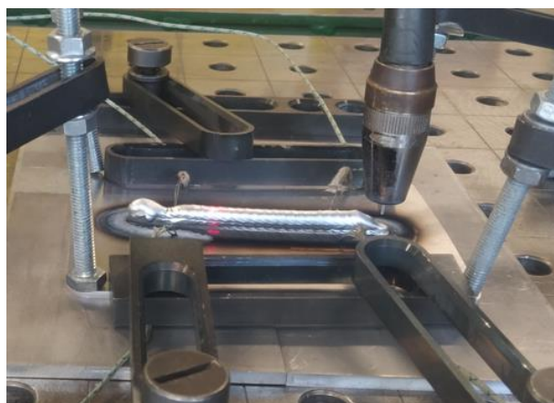
Obr. 90 a 91 – Navařená stěna po 1. housence (vlevo) a 3. housence (vpravo)
