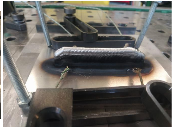
Obr. 92 a 93 – Navařená stěna po 7. housence (vlevo) a 10. housence (vpravo)
