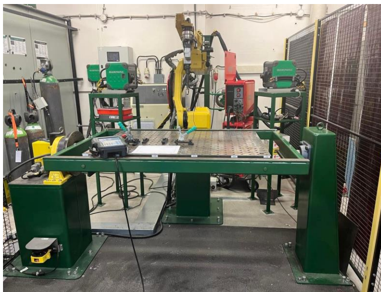
Obr. 43 – Robotické svařovací pracoviště FS, UST
