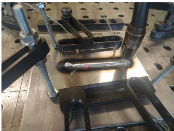
Obr. 90 a 91 – Navařená stěna po 1. housence (vlevo) a 3. housence (vpravo)
