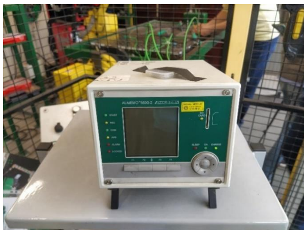
Obr. 45 – Měřící stanice Ahlborn Almemo 5690-2
