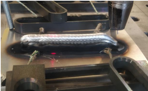
Obr. 92 a 93 – Navařená stěna po 7. housence (vlevo) a 10. housence (vpravo)
