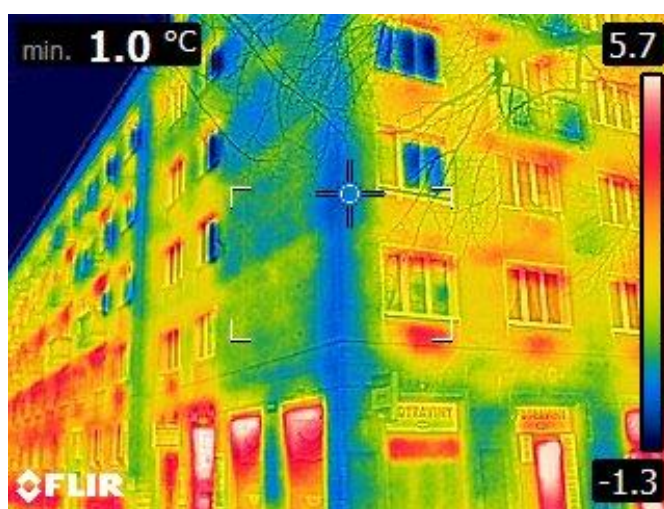
Obr. 36 – Ukázka termogramu panelového domu [47]
