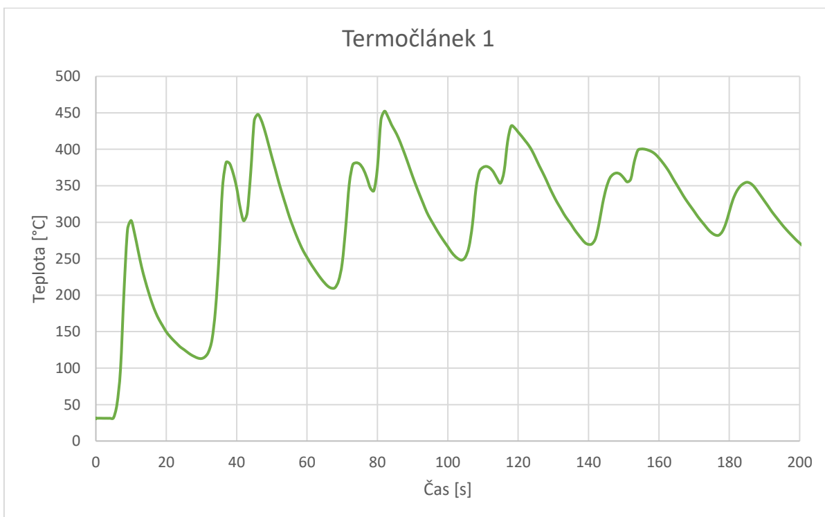
Obr. 62 – Ukázka záznam teploty v závislosti na čase u termočláneků č. 1
