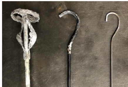
Obr. 63 Zkoumaná míchadla. Vlevo nakoupené míchadlo na barvy a stavební směs, uprostřed míchadlo z tlustého drátu, vpravo míchadlo z tenkého drátu
