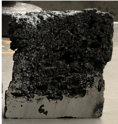
Obr. 66 Pěna se "spálenými póry" a vysokou vrstvou stečení
