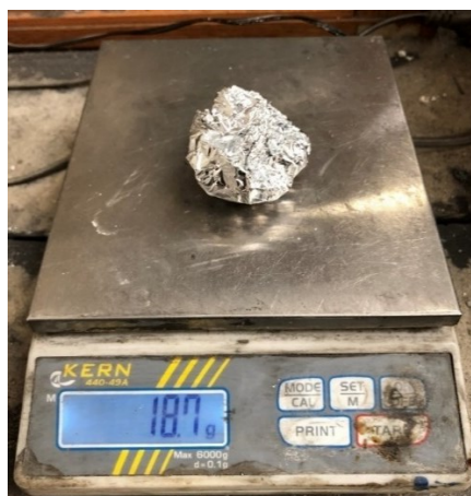
Obr. 67 Kulička alobalu se zabaleným práškem \text{CaCO}_3 na slévárenské váze
