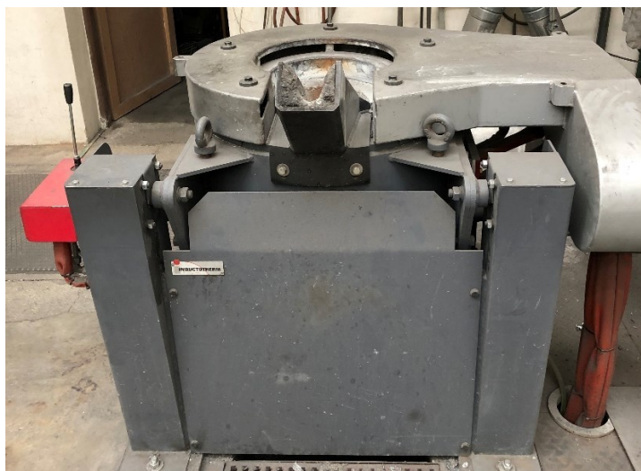
Obr. 49 Idukční pec Inductotherm
