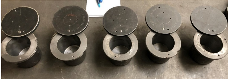
Obr. 41 Foto výsledných vyrobených kokil
