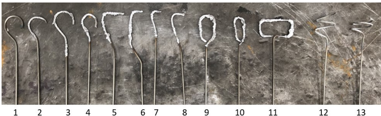
Obr. 64 Zkoumaná míchadla z tenkého svařovacího drátu o průměru 3 mm
