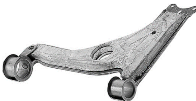
Obr. 14 Závěsná část tlumiče vyztužená hliníkovou pěnou [8]
