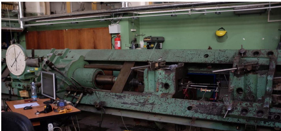
Obrázek 32: Zkušební stroj Alfred Amsler s instalovaným vzorkem
