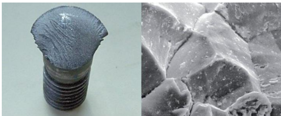
Obrázek 1: Lom způsobený vodíkovou křehkostí [33]
