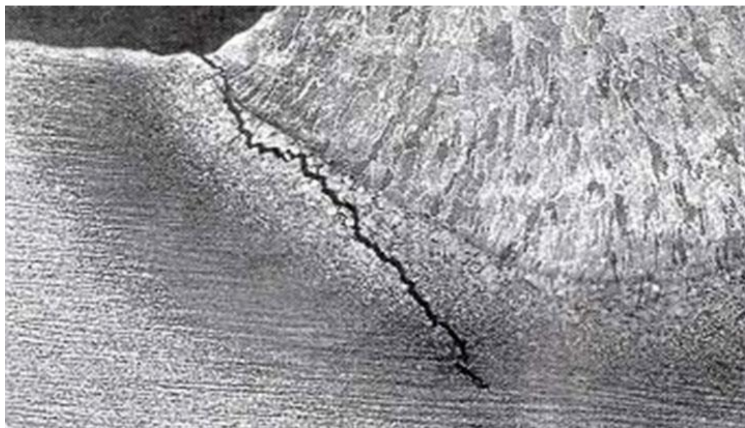
Obrázek 4: Vodíková trhlina ve svarovém spoji [32]
