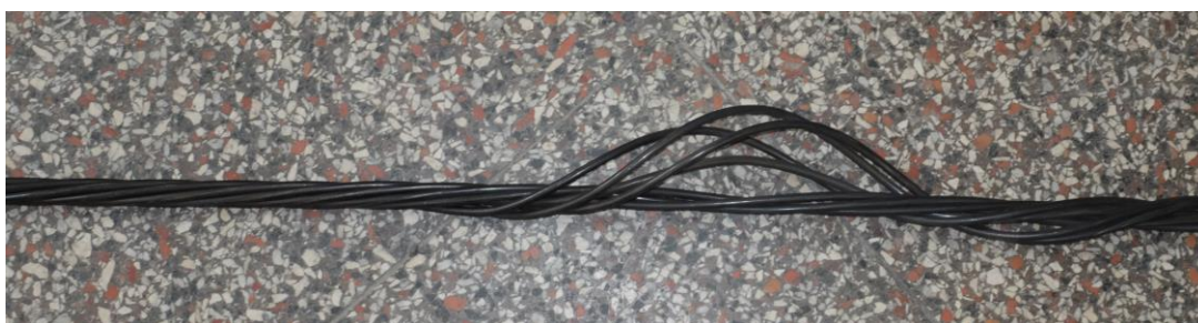
Obrázek 22: Rozpletené předpínací lano po zkoušce tahem
