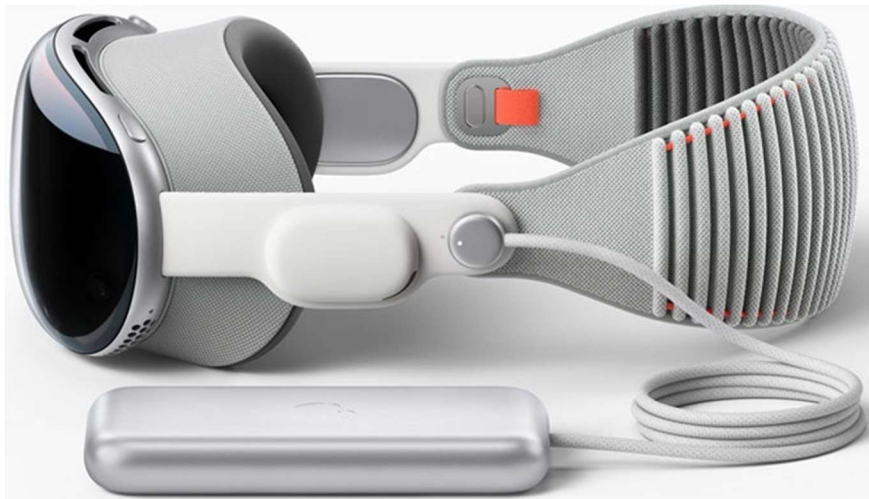
Obr. 15: Apple Vision Pro s externí baterií, snižující celkovou hmotnost
