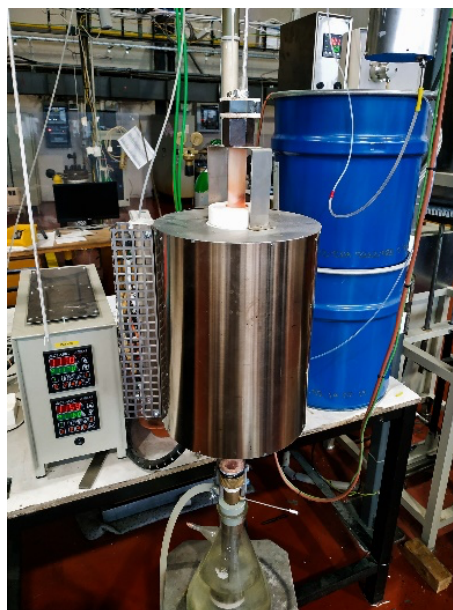
Obr. 19: Experimentální zařízení pro provádění zkoušek vysokoteplotní oxidace v páře; vlevo schéma, vpravo skutečné zařízení.
