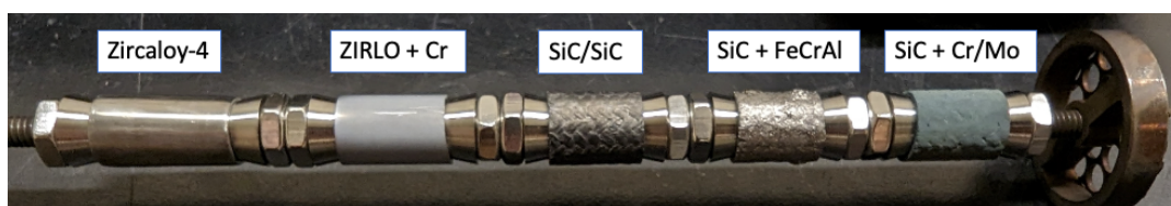
Obr. 27: Umístění vzorků do dynamického autoklávu.
