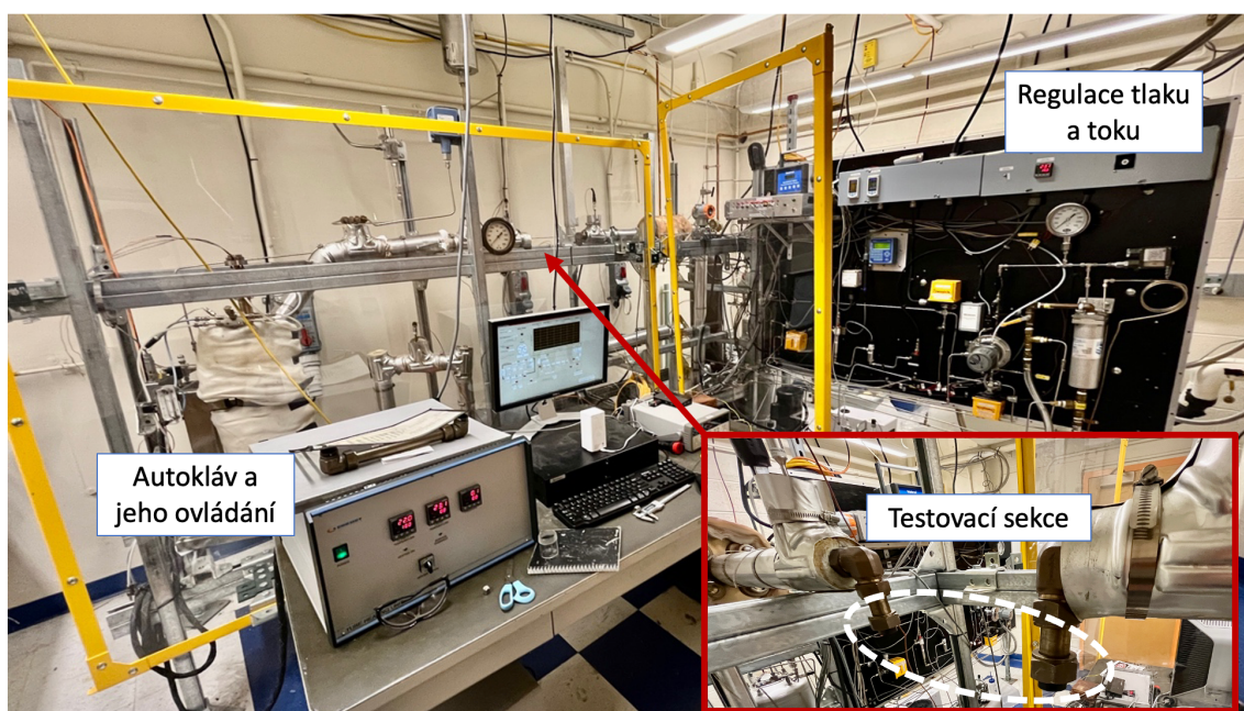
Obr. 26: Vysokoteplotní, vysokotlaká smyčka („CRUD loop“).
