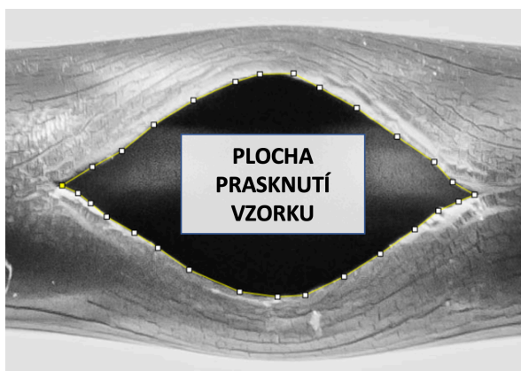
Obr. 23: Měření plochy trhliny pomocí programu ImageJ.
