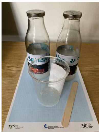
Obrázek 3.9: Láhve se silikonem a katalyzátorem, nástroje pro jejich smíchání
