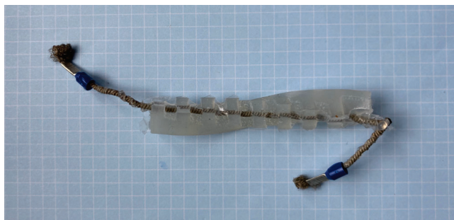
Obrázek 3.16: Snímek zkrouceného modelu ZM po vyjmutí z formy
