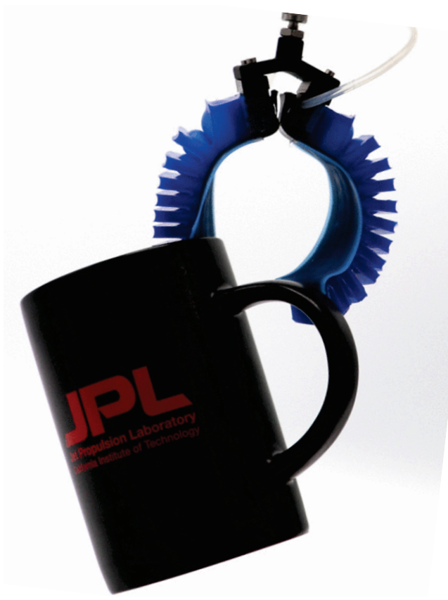
Obrázek 2.5: Pneumatický ovládaný gripper s geckoadhezí, (hmotnost hrnku = 400g) [4],(© 2018, IEEE)
