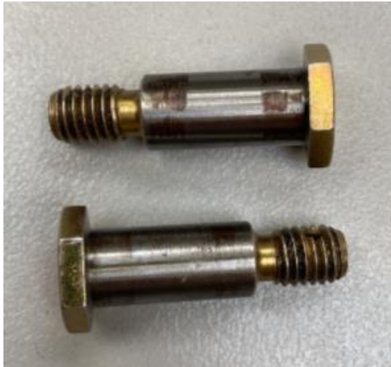
Obrázek 48 Dodaný čep – materiál L-CM3.7 – již opotřebované kusy
