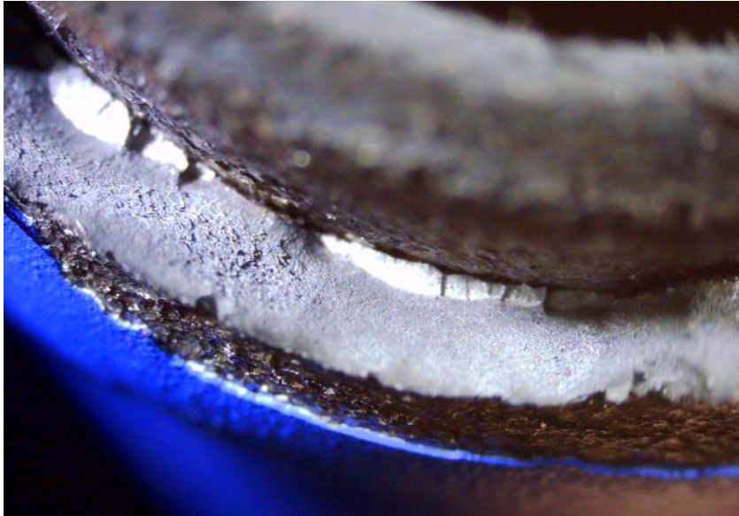
Obrázek 61 Vznik iniciace trhliny – výsledky z mikroskopu - 1
