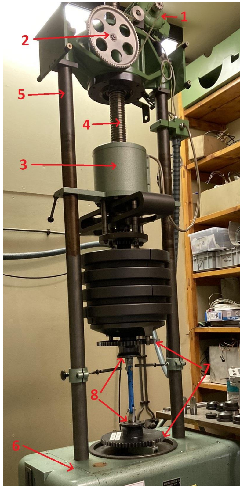
Obrázek 39 Amslerův vysokofrekvenční pulzátor – popis stroje
