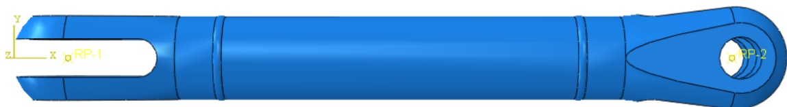
Obrázek 66 Metoda strukturálních hot spot napětí – příprava vzorku v Abaqusu
