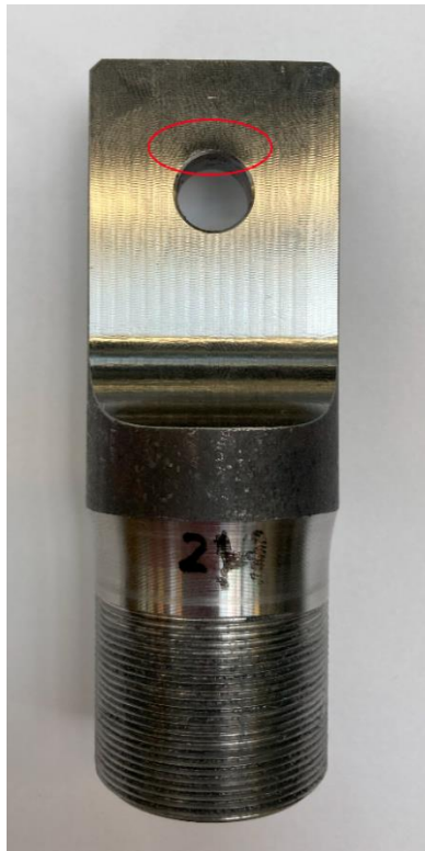
Obrázek 54 Závěsné redukce – varianta 2 - zobrazení poškození
