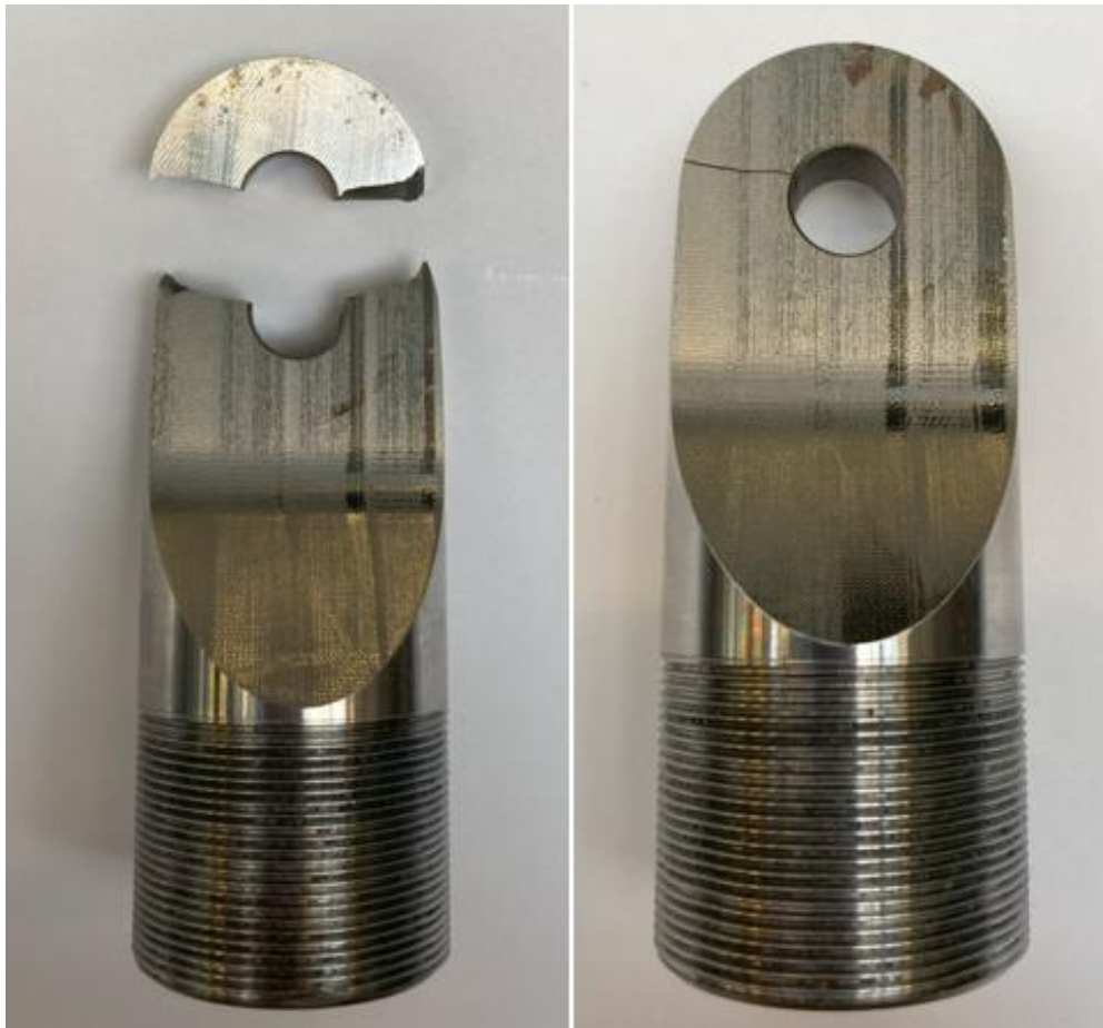
Obrázek 52 Závěsné redukce – varianta 1 - zobrazení poškození
