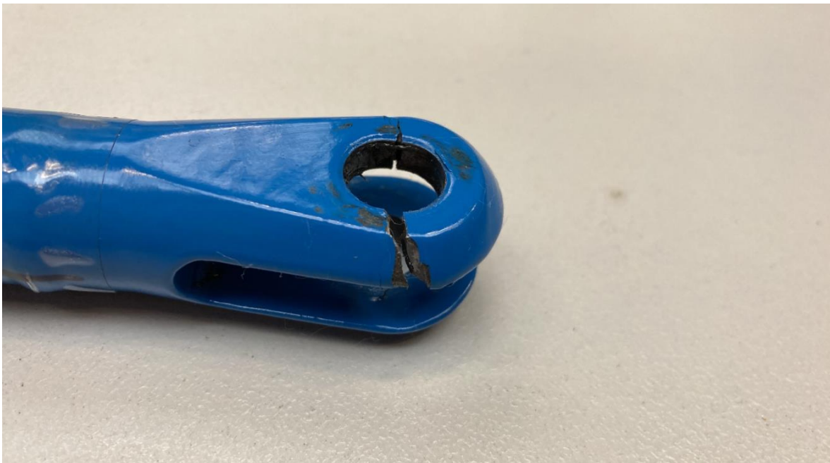
Obrázek 56 Testovaný vzorek – prasklina ve vidlici
