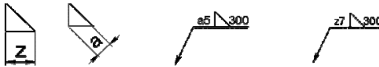
Obrázek 26 Označování hlavních rozměrů [12]
