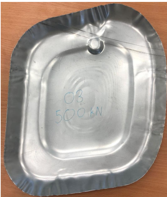
Obrázek 72 První operace, třetí přístřih 500 kN lisovací síla
