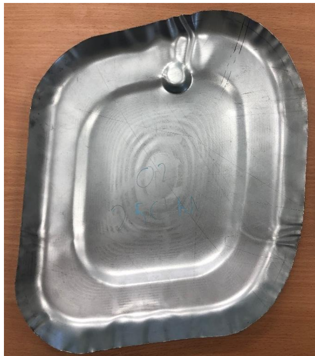
Obrázek 71 První operace, druhý přístřih 250 kN lisovací síla
