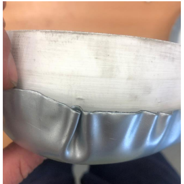
Obrázek 81 Otlačení nástroje a přeložení plechu
