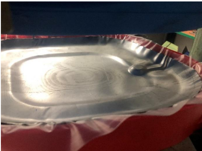
Obrázek 70 První operace, první přístřih 600 kN lisovací síla
