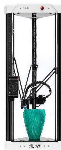
Obrázek 9 Delta FDM 3D tiskárna [41]
